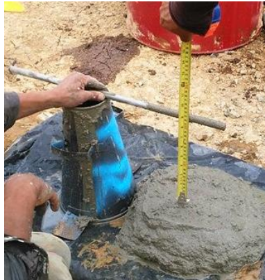
Figura No. 49 Ensayo de asentamiento SLUMP. Fuente propia.
