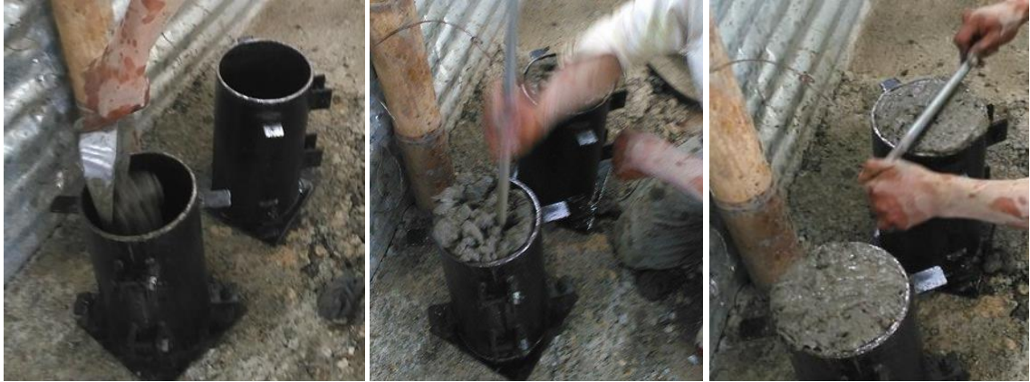
Figura No. 46 Elaboración de cilindros de concreto. Fuente propia.
