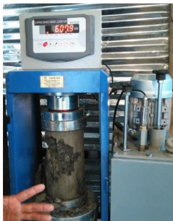
Figura No. 48 Ensayo de resistencia a la compresión del concreto. Fuente propia.
