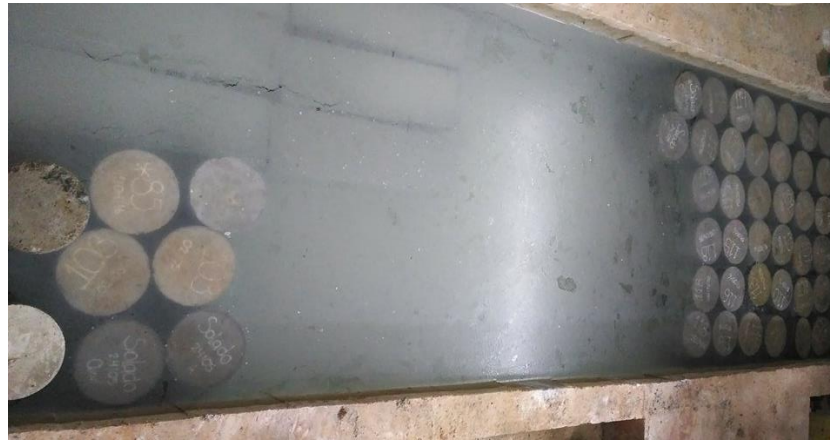
Figura No. 47 Almacenamiento de muestras de concreto en tanque de agua saturada con cal. Fuente propia.
