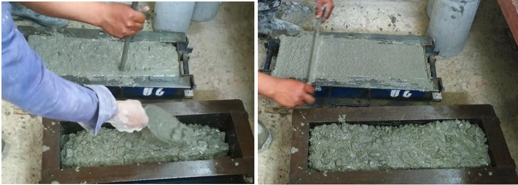
Figura No. 50 Elaboración de viguetas para ensayo de resistencia a la flexión. Fuente propia.
