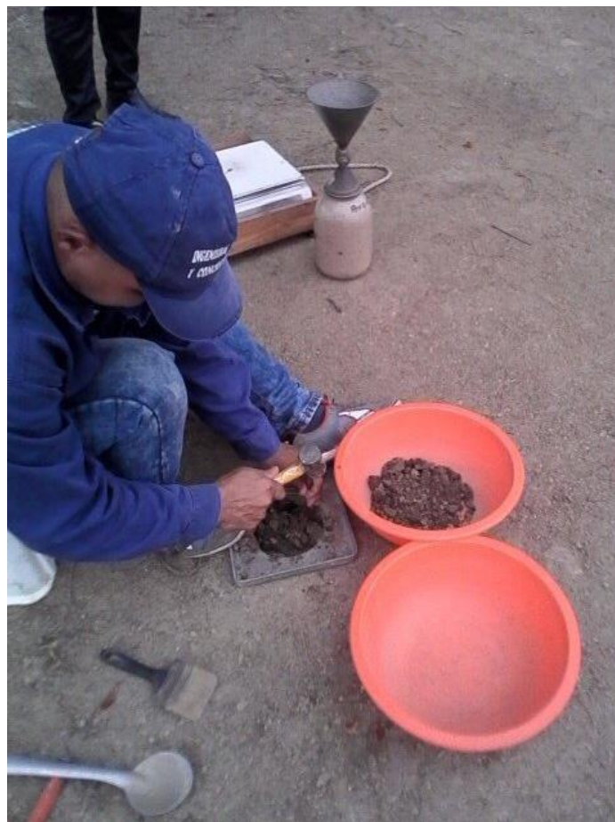
Figura 22. Ensayo de densidad ( Cono de Arena)
