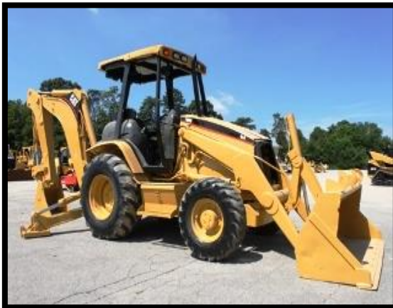
Figura 32. Retro cargador CAT 420D. (Fuente: Propia)
