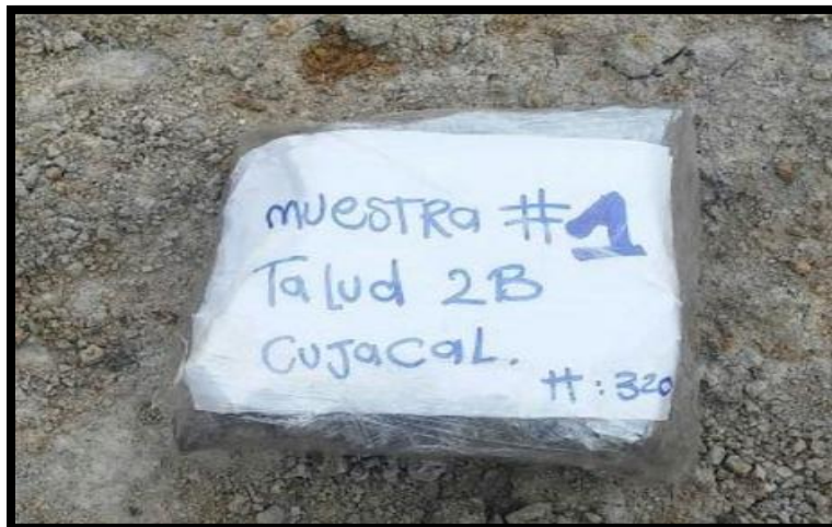
Figura 106. Muestra inalterado talud 2B. (Fuente: Propia).
