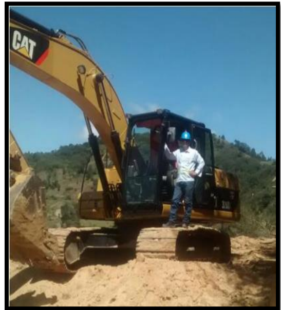
Figura 30. Excavadora CAT 320DL. (Fuente: Propia)
