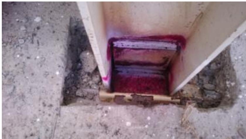
*Figura 38. Inspección de soldadura por líquidos penetrantes. (Fuente: Autoría Propia)*
