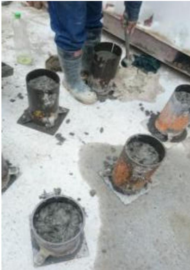
*Figura 71. Toma de muestra del concreto utilizado para columnas, pantallas y cimentación (Fuente: Autoría Propia).*
