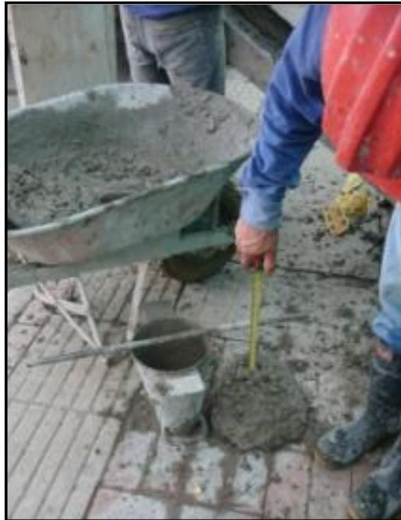
*Figura 55. Prueba de asentamiento del concreto. (Fuente: Autoría Propia)*
