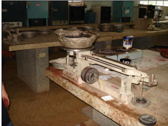
IMAGEN N° 49. Pesada de muestra de mezcla asfáltica para medición de Gmm.
