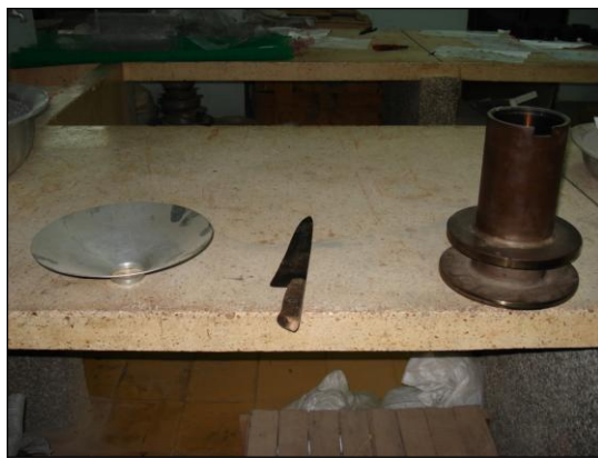
IMAGEN N° 53. Molde de compactación
