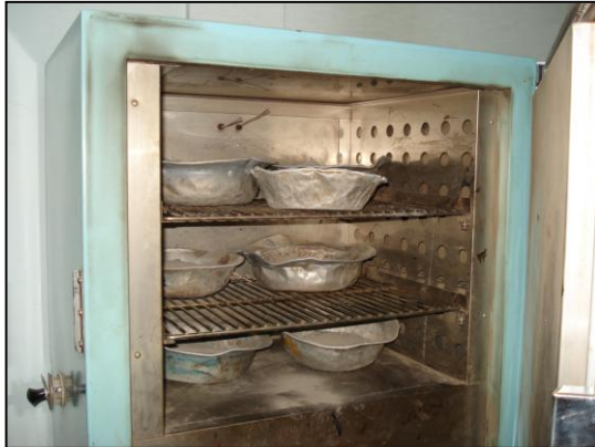
IMAGEN N° 41. Secado de agregados
