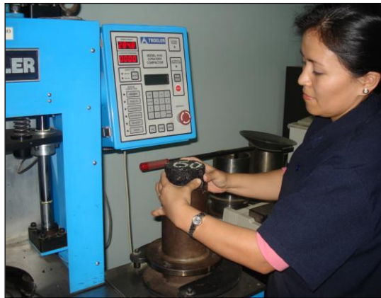
IMAGEN N° 64. Disposición del espécimen acondicionado en el molde de compactación
