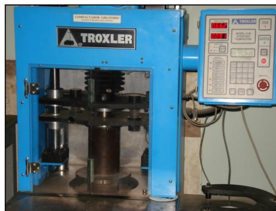
FIGURA N° 66. Compactación adicional de especímenes en condiciones de servicio.
