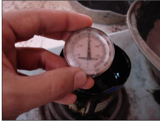
IMAGEN N° 44. Calentamiento del asfalto para que adquiera la viscosidad de mezclado
