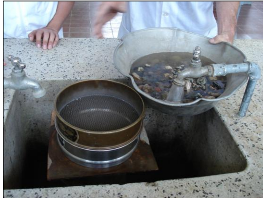
IMAGEN N° 3. Tamizado por vía húmeda.
