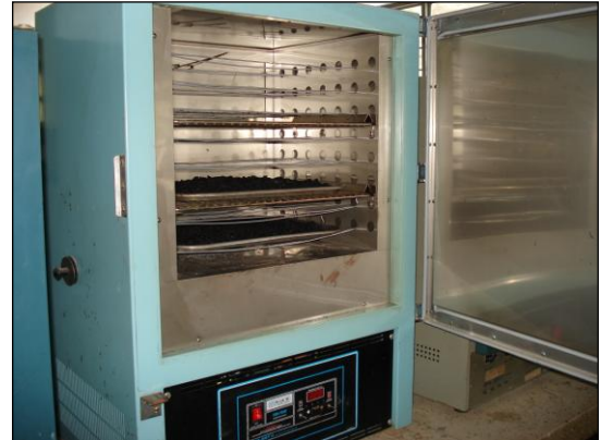
IMAGEN N° 50. Acondicionamiento de muestras de mezcla asfáltica para medir Gmm.
