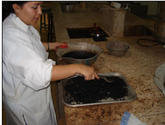
IMAGEN N° 46. Disposición de la mezcla en bandeja para la elaboración de especímenes.
