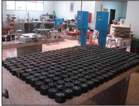
IMAGEN N° 56. Especímenes elaborados para las diferentes combinaciones de gradación, IPL y % de Va
