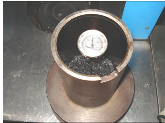
IMAGEN N° 60. Control de la temperatura de compactación
