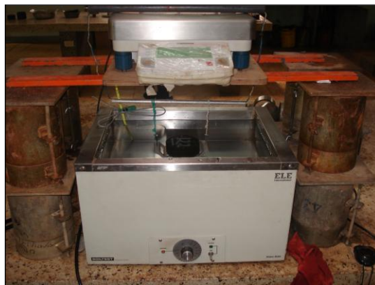
FIGURA N° 57. Determinación del peso en el agua de cada espécimen para la medición del Gmb.
