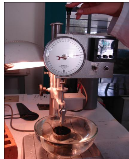
IMAGEN N° 23. Ensayo de penetración
