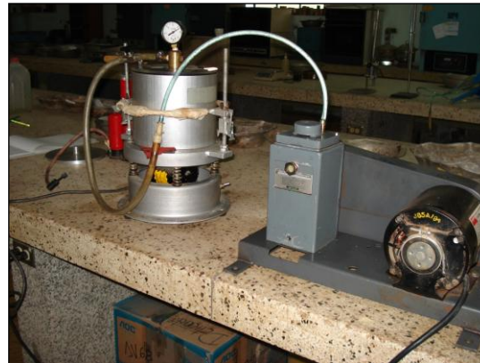
IMAGEN N° 51. Equipo para la determinación del Gmm.
