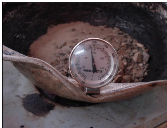
IMAGEN N° 43. Calentamiento de agregados para elaboración de mezclas
