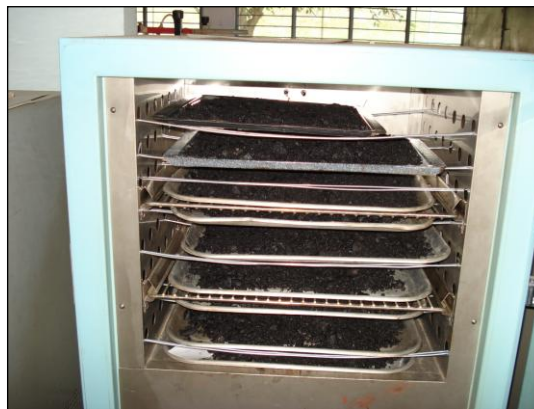
IMAGEN N° 48. Acondicionamiento de las mezclas a corto plazo.
