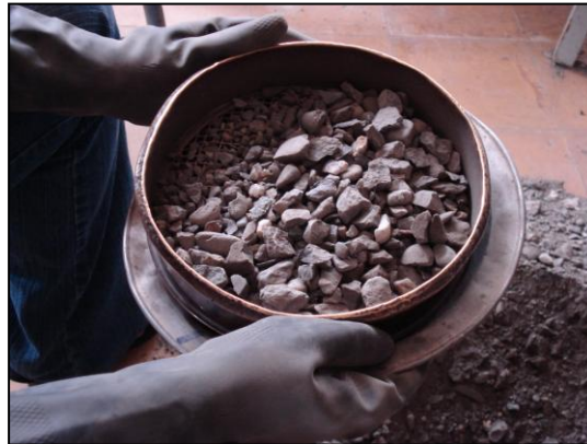
IIIMAGEN N° 34. Tamizado de agregados
