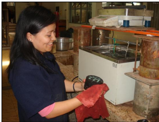
IMAGEN N° 67. Determinación de la masa del espécimen en condición saturada y superficialmente seca, para la medición del Gmb de los especímenes compactados con energía adicional.
