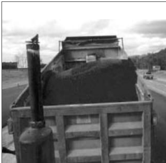
IMAGEN N° 24. Mezcla asfáltica en el habitáculo de una volqueta Fuente: Revista facultad de Ingeniería Universidad de Antioquia No. 36
