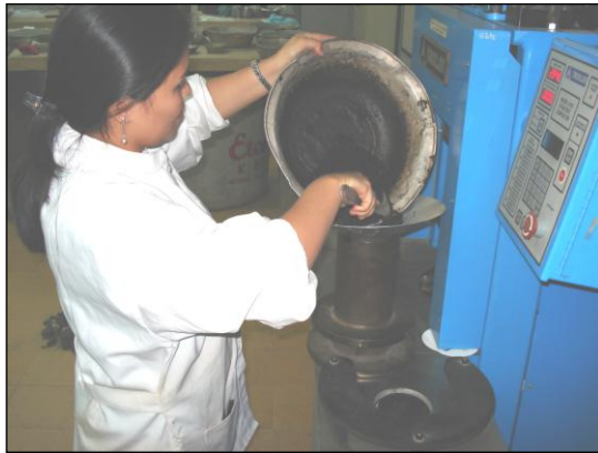
IMAGEN N° 59. Colocación de la mezcla en el molde de compactación
