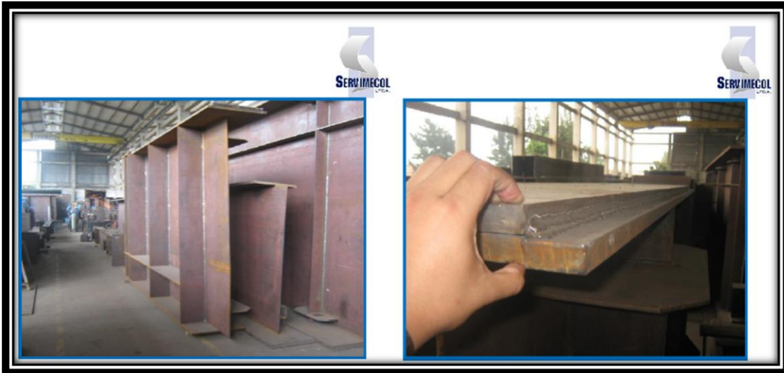
FIGURA 63: SECCIONES DE VIGAS METÁLICAS.
