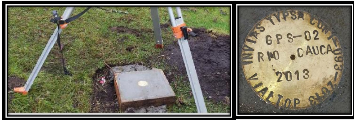
FIGURA 11: MOJON COLOCADO POR TYP SA.
