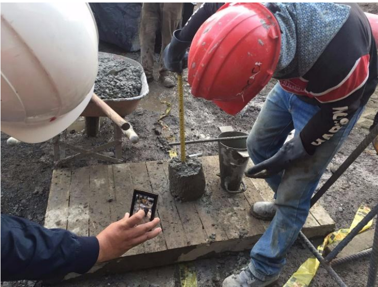
Figura No.30 Ensayo de asentamiento o Slump
