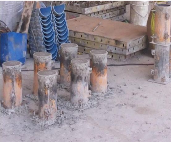
Figura No 29 Toma de muestras para ensayo de resistencia a la compresión.
