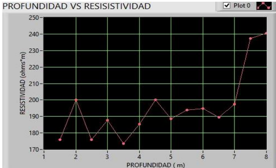
Figura 51 Curva de resistividad vs profundidad
