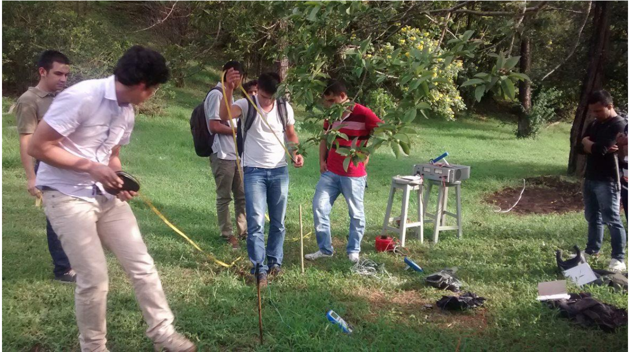
Figura 44. Sondeo eléctrico vertical frente a FIC (Mayo 2016)
