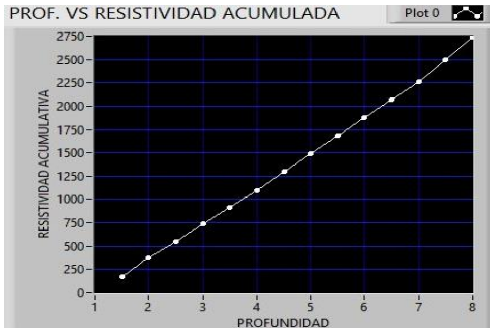
Figura 52 Curva de resistividad acumulada vs profundidad
