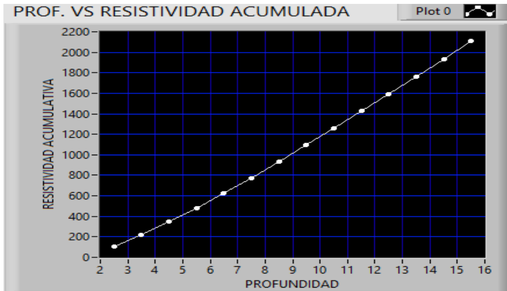
Figura 48. Curva de resultado resistividad acumulada vs profundidad
