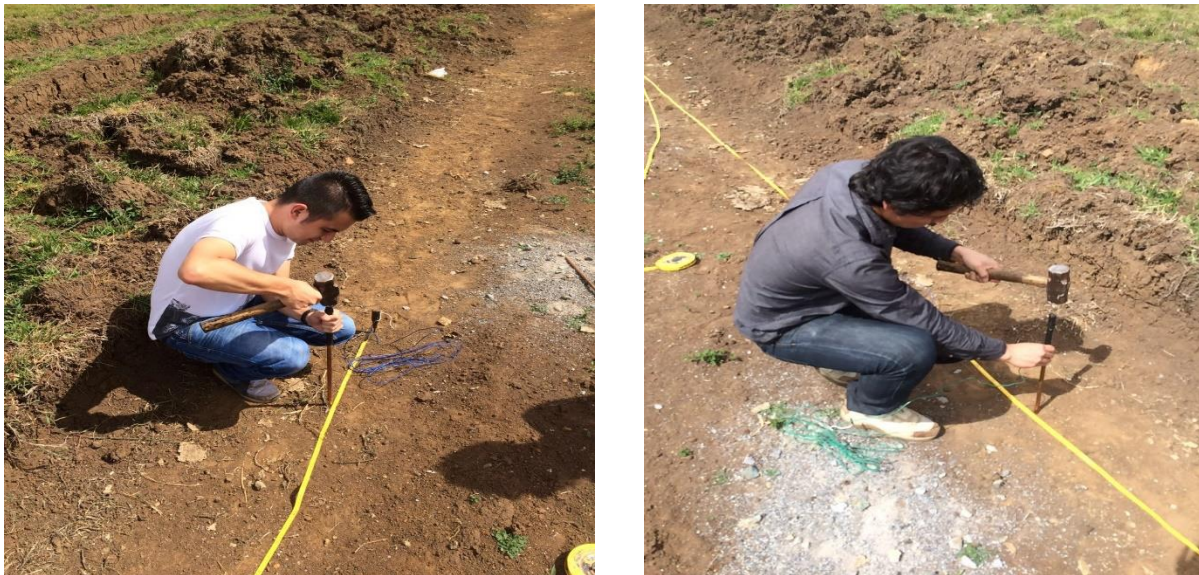
Figura 38. Fotografía durante la colocación de electrodos y medición de distancias (Agosto 2016)
