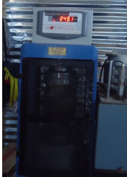
Figura No. 54 Ensayo de resistencia a la compresión del concreto
