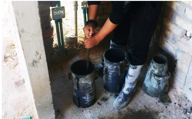
Figura No.50 Toma de muestras para ensayos de resistencia a la compresión.
