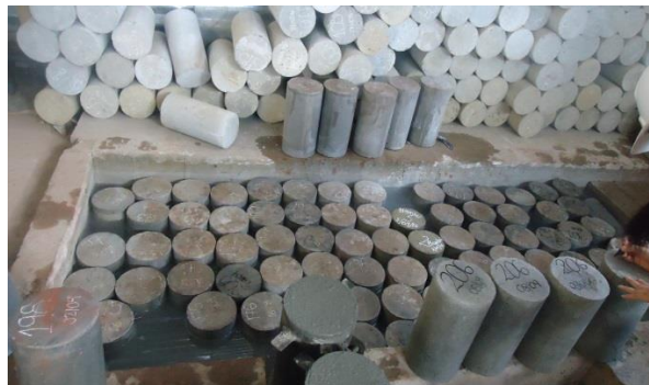
Figura No.52 Cilindros para ensayos de resistencia a la compresión
