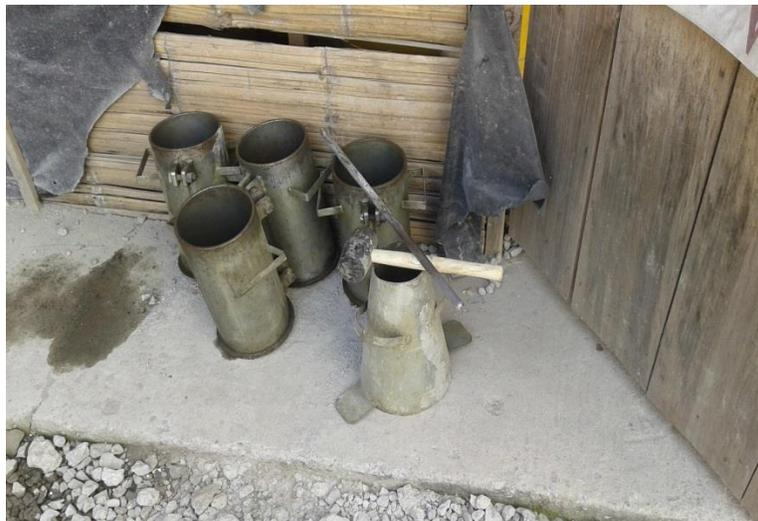
**Figura 32. Equipo para toma de muestras del concreto**
