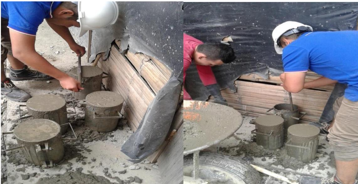
**Figura 33. Toma de cilindros de concreto 1**
