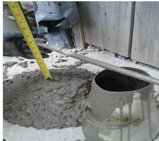
**Figura 30. Lectura del asentamiento 1    Figura 31. Lectura del asentamiento 2**
