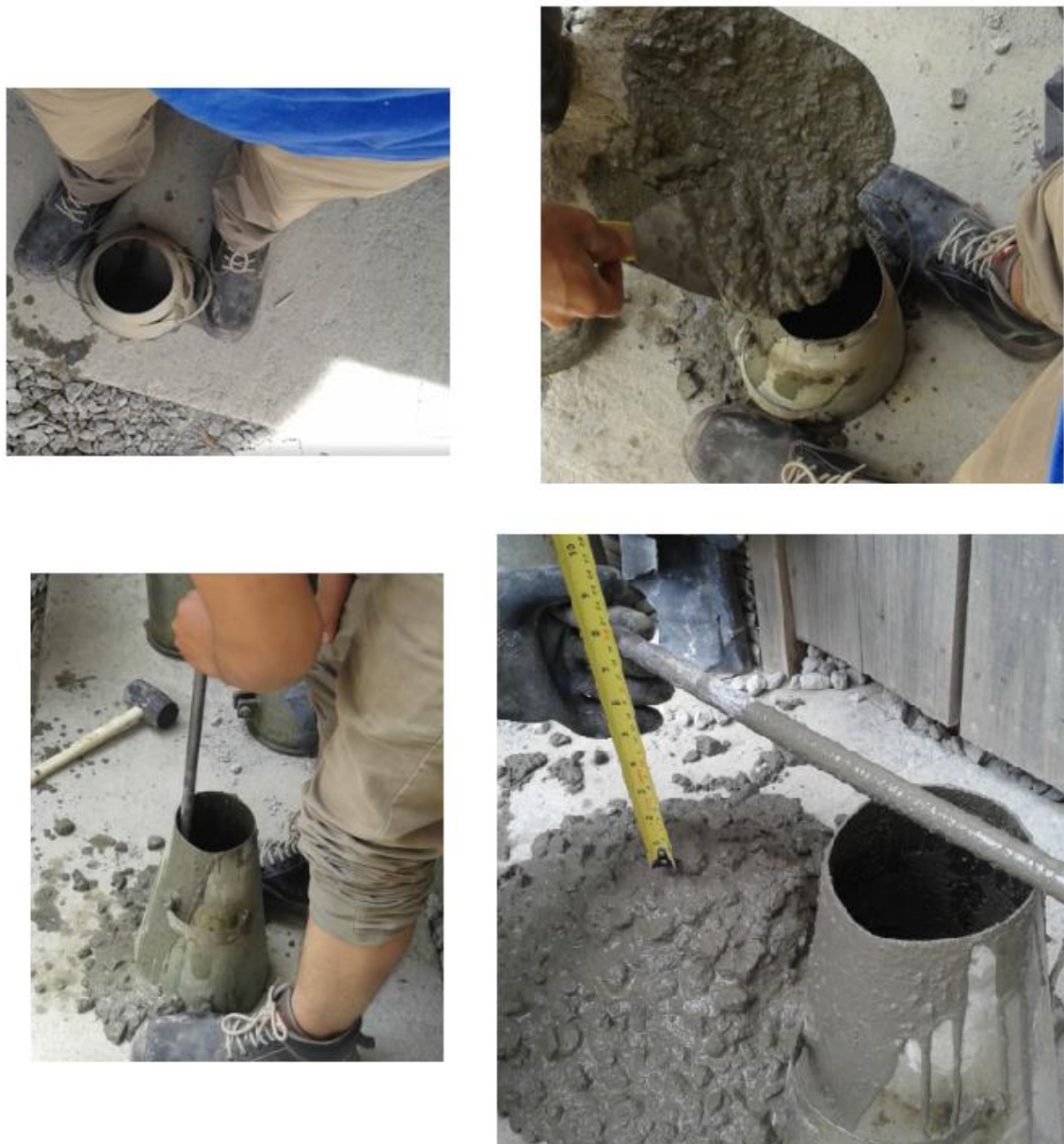
Ilustración 47. Ensayo de asentamiento.
