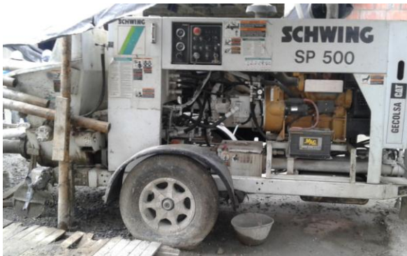
Ilustración 40. Bomba de concreto.
