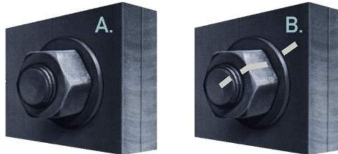
Figura 60. Marca para ajuste a 2/3 de giro
