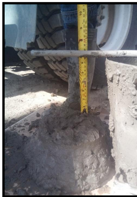
Figura 27. Resultado de ensayo de asentamiento, 27/08/2015
