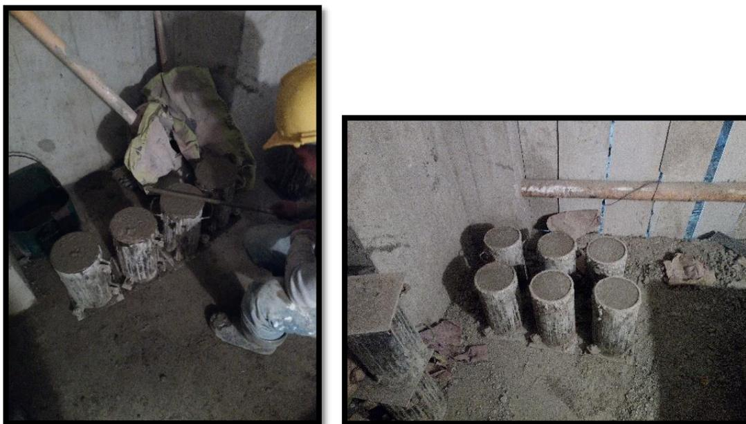
**Figura 35. Elaboración de las probetas cilíndricas.**
