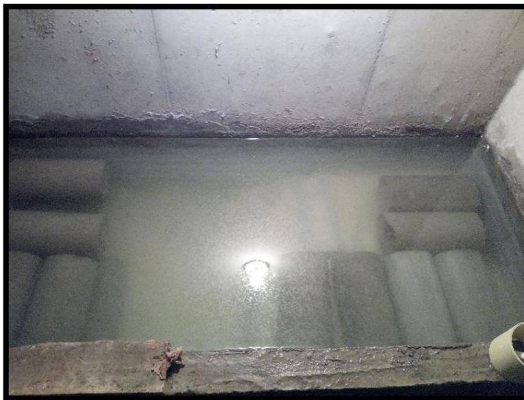
**Figura 36. Curado de las probetas.**
