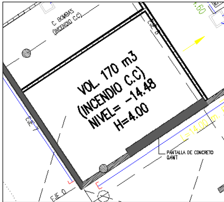
Figura No. 7 Ubicación tanque de abastecimiento de agua para red contra incendios en AutoCad. Fuente propia
