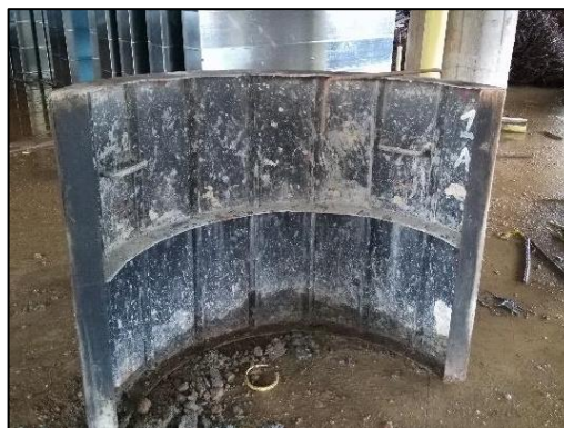
Figura No. 19 Formaleta para cámara de inspección de altura 1m. Fuente propia.
