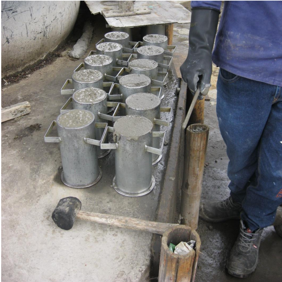
Figura N° 60: Muestras de fundición de apartamento.
