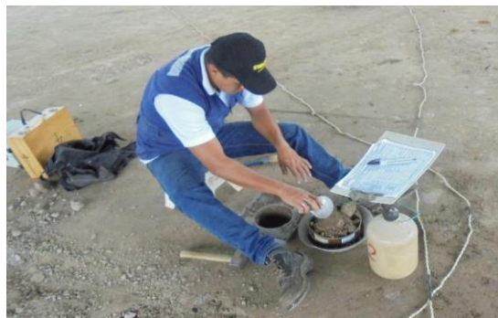
Figura 15 Realización del espacio para llenar con arena de densidad conocida (Cono de arena). Fuente Contrato 1318-2013
