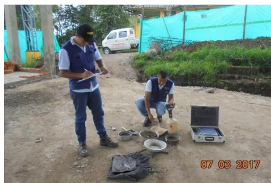
Figura 15 Realización del espacio para llenar con arena de densidad conocida (Cono de arena). Fuente Contrato 1318-2013
