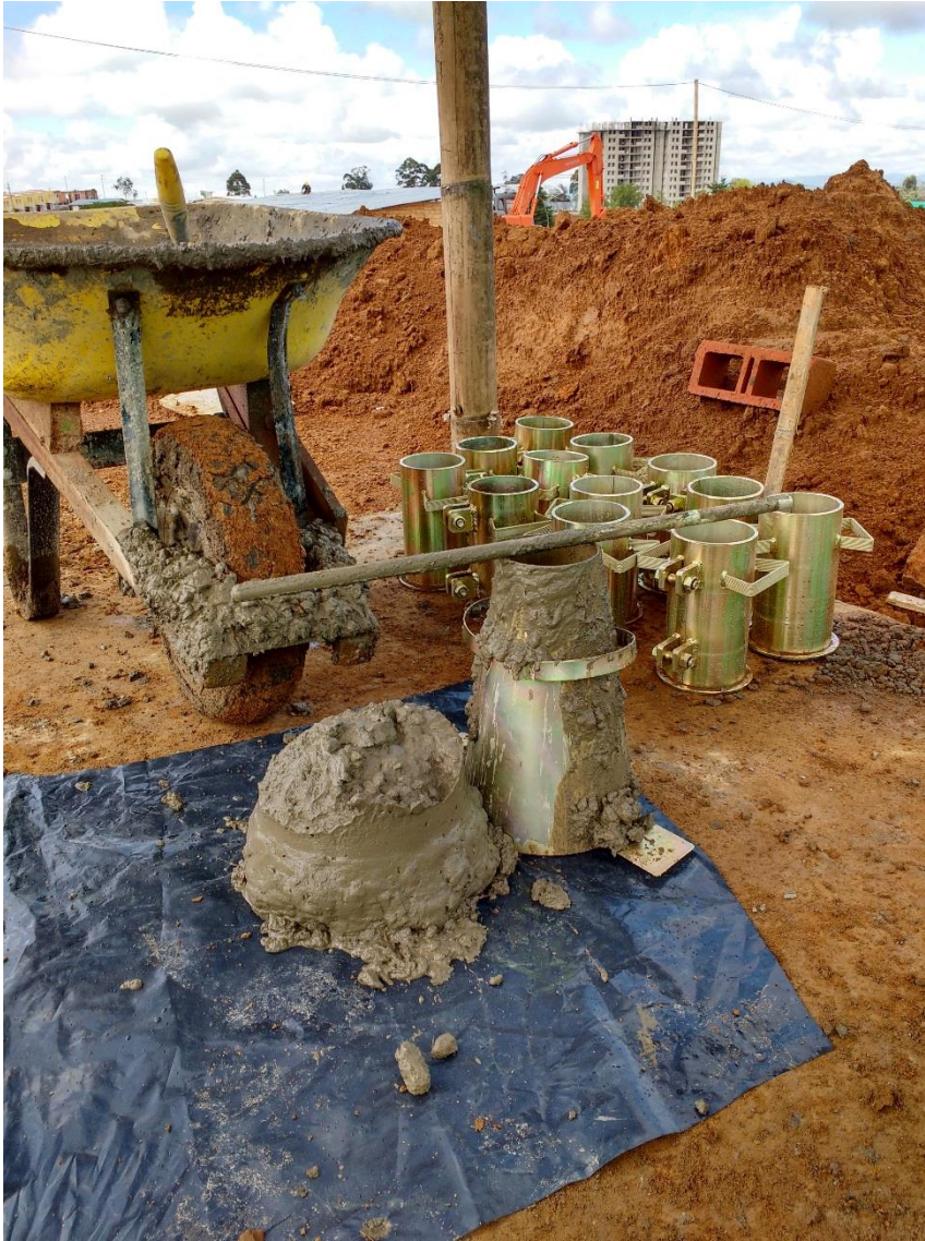
Figura 32. Asentamiento con adición de 3 cuñetes de agua
