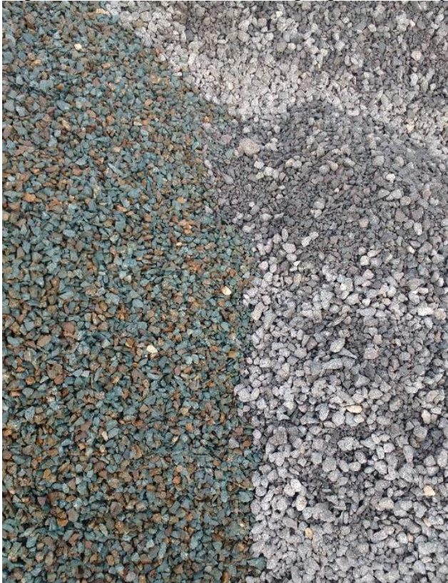
Figura 18. Diferencia entre agregados 3/8" y 3/4"
