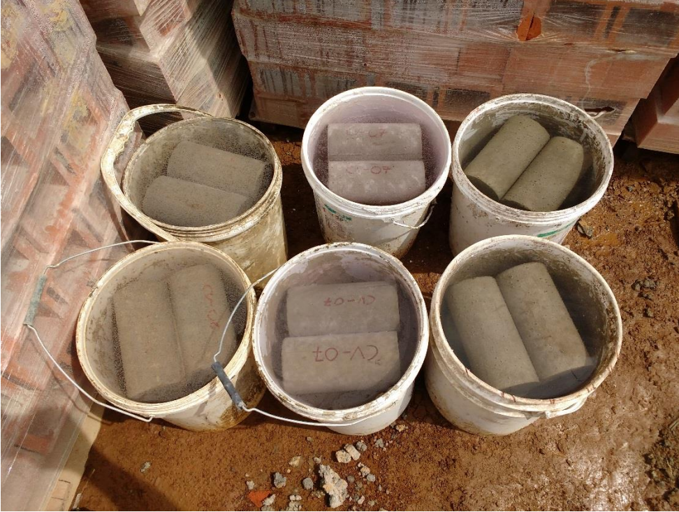
Figura 40. Curado de muestras en agua saturada con cal
