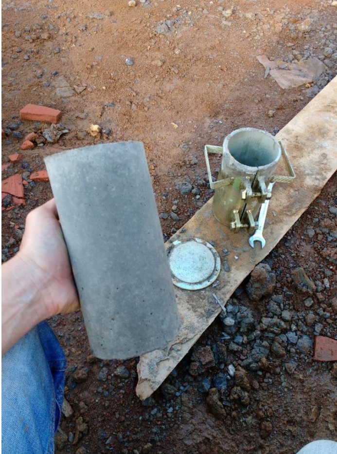
Figura 39. Desencofrado de cilindros de prueba
