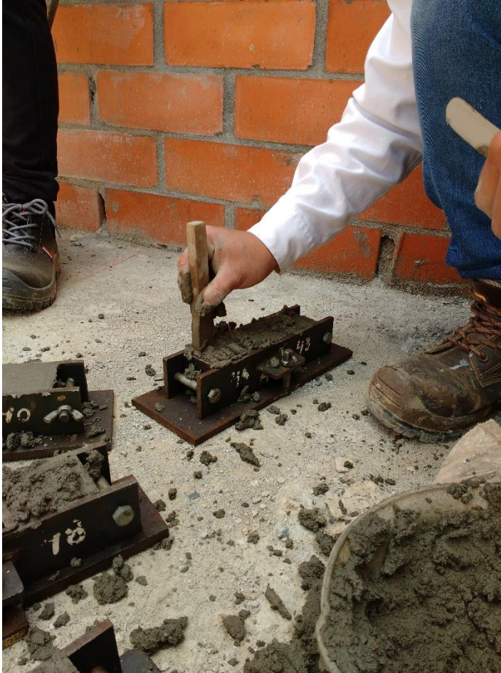
Figura 52. Ensayo mortero de pega
