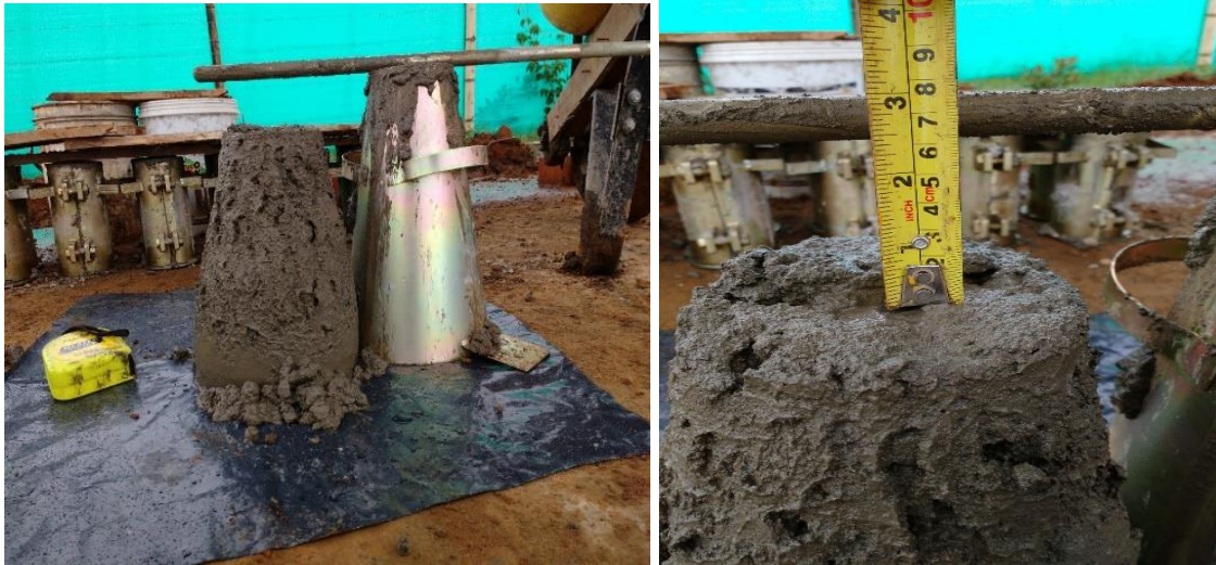
Figura 33. Asentamiento con dos cuñetes de agua
