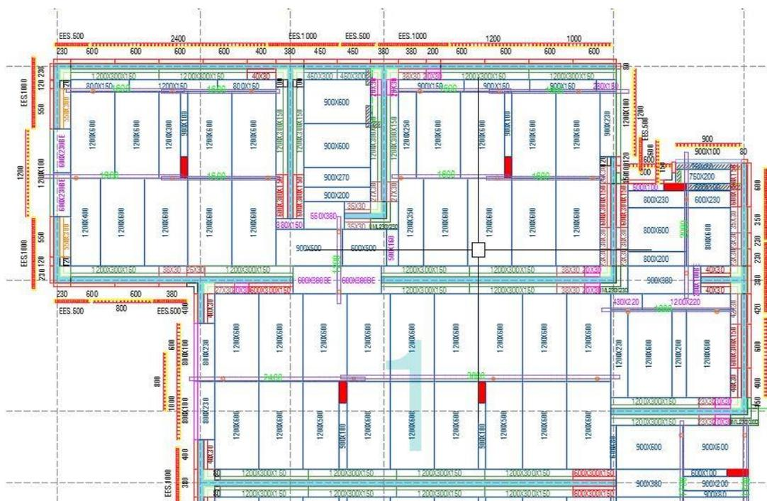
Figura 10: Modulación de formaleta metálica para losas Fuente: UNISPAN, Soluciones de encofrado y andamios.
