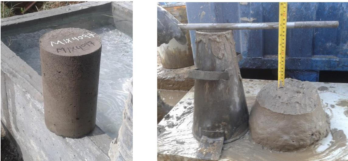
Figura 21: Cilindro para ensayo de rotura y prueba de slump o de cono. Fuente: Elaboración propia
