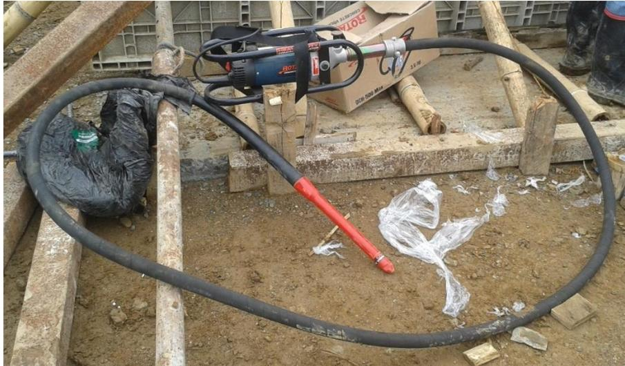
*Figura 18: Vibrador que se utiliza en fundición. Fuente: Elaboración propia.*
