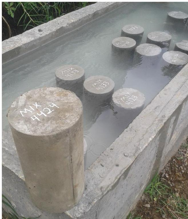
Figura 23: Fraguado de las muestras de concreto. Fuente Elaboración propia.
