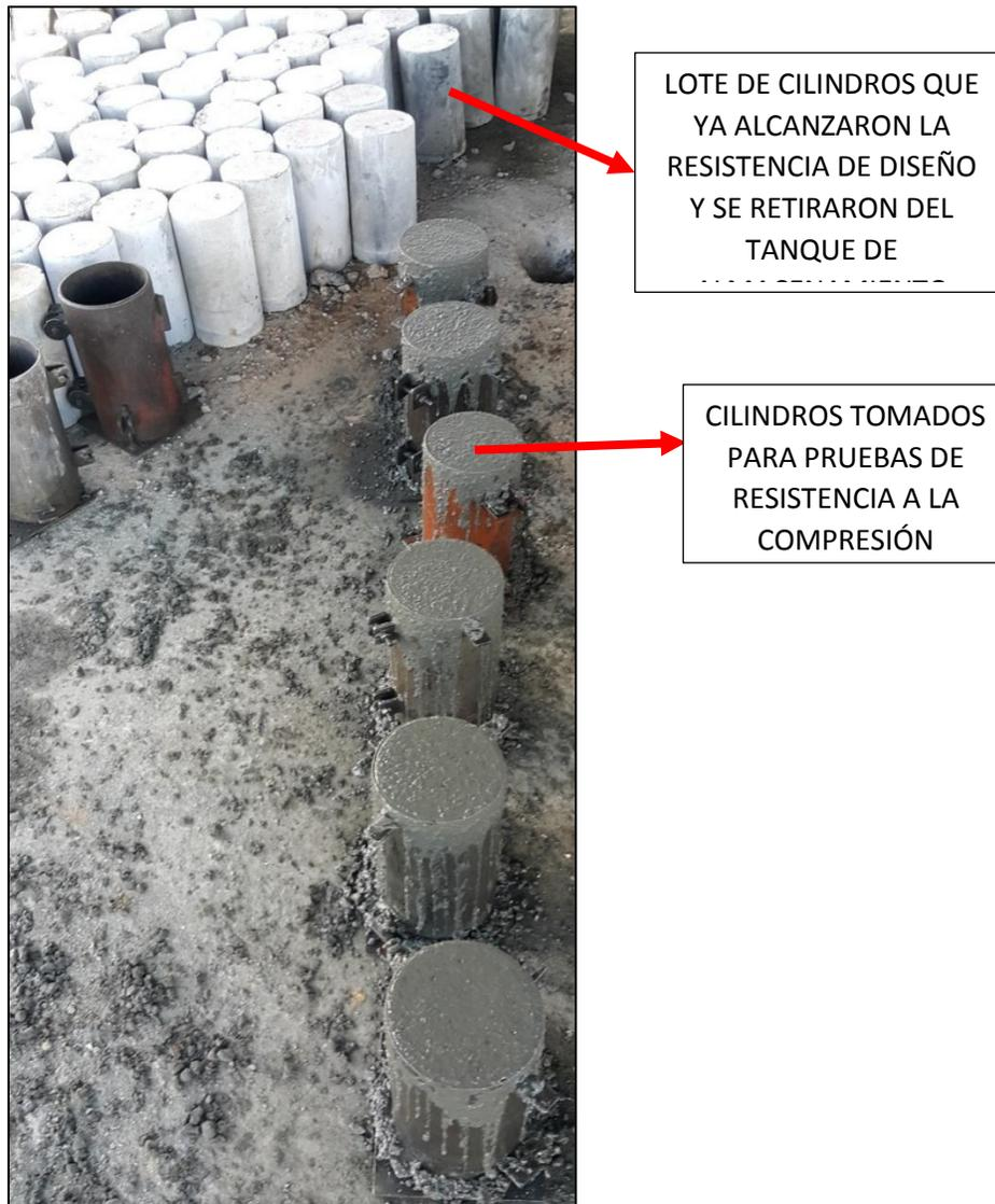
*Figura N° 9a: Toma de cilindros para pruebas de resistencia a la compresión y retiro de cilindros del tanque de almacenamiento.*
