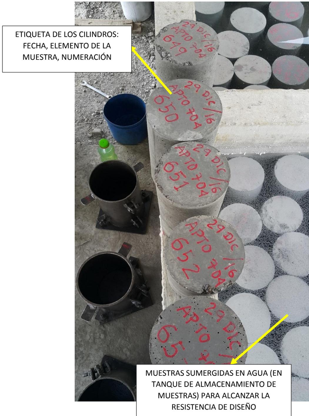
Figura N° 9b: Etiqueta de cilindros y muestras sumergidas en tanque de almacenamiento
