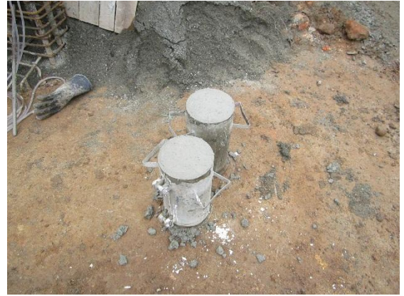
Foto 49: Cilindros de prueba.
