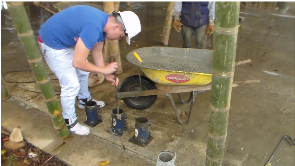
Figura 26. toma de muestra de cilindros
