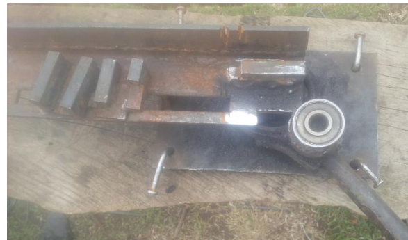
Foto 5. Dispositivo para flejar acero. Fuente Construcción propia
