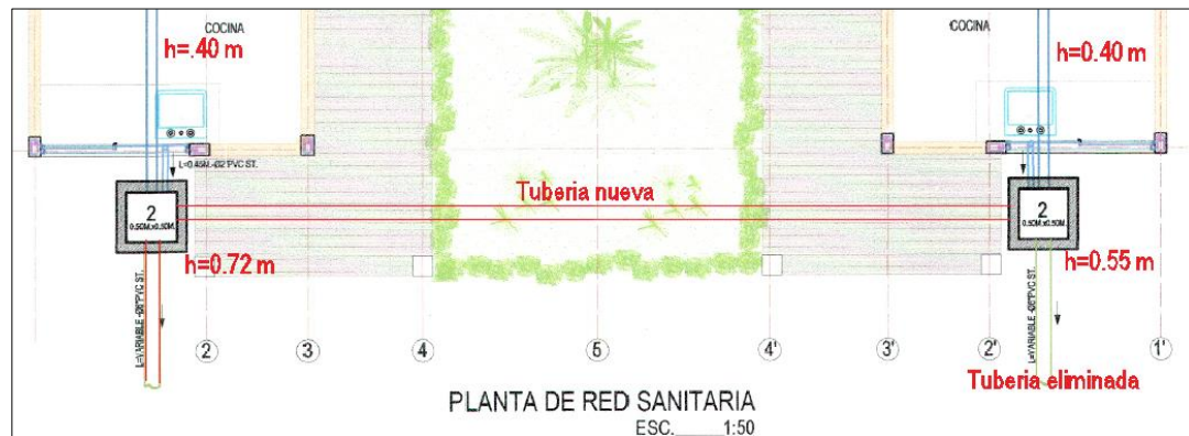
Figura 6. Detalle de la modificación de la red sanitaria. Fuente Construcción propia
