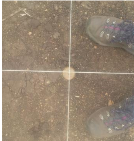
Foto 8. Estaca de punto base. Fuente Construcción propia
