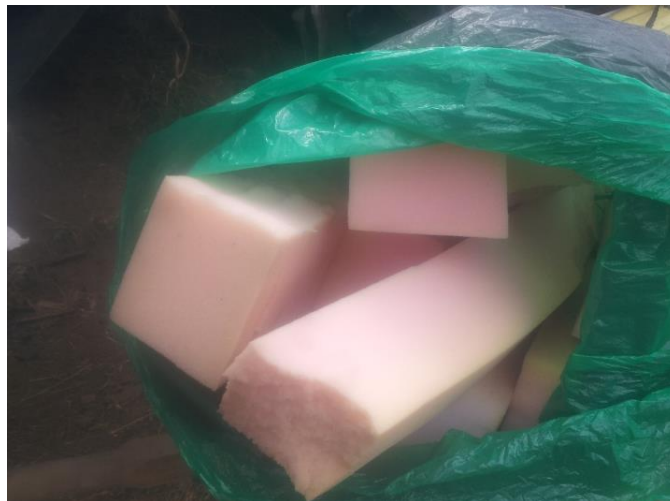
Foto 23. Espuma para limpiar ladrillo. Fuente Construcción propia
