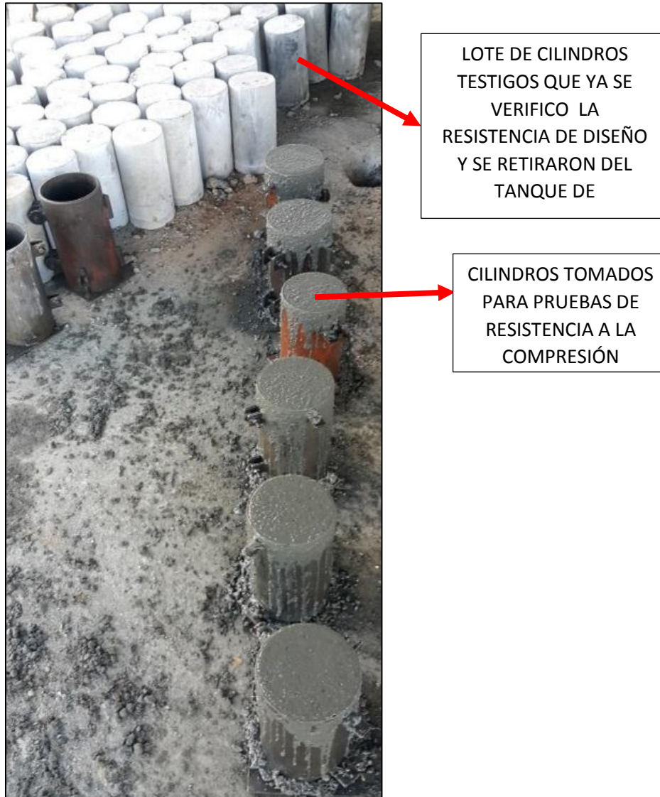
Figura N° 12a: Toma de cilindros para pruebas de resistencia a la compresión y retiro de cilindros del tanque de almacenamiento.
