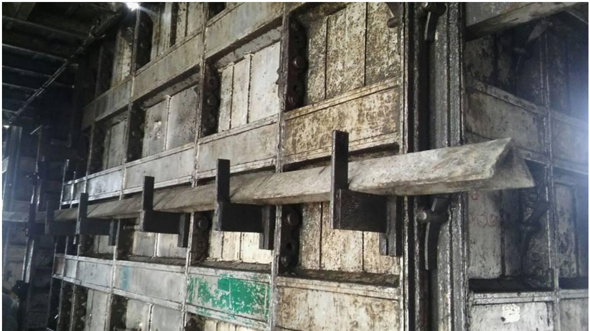
Figura N° 11c: Alineadores de la formaleta. Fuente: Propia
