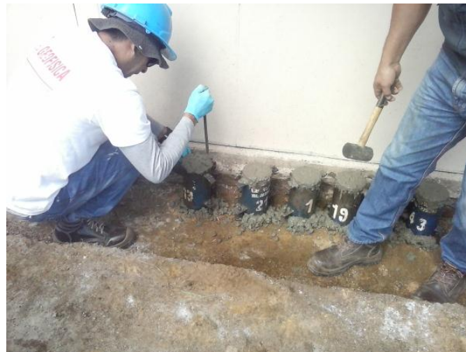
Figura 28. Elaboración de cilindros de concreto para control de calidad. Fuente: El autor.
