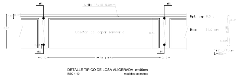
Figura 44. Detalle típico losa aligerada.
