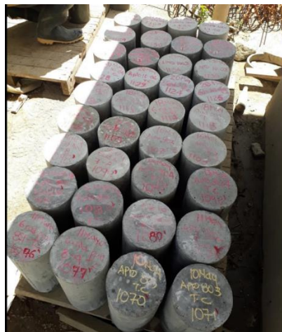
Figura 44: Cilindros para ensayo de resistencia a la compresión
