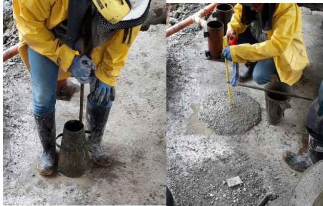
Figura 21: Ensayo de asentamiento del concreto
