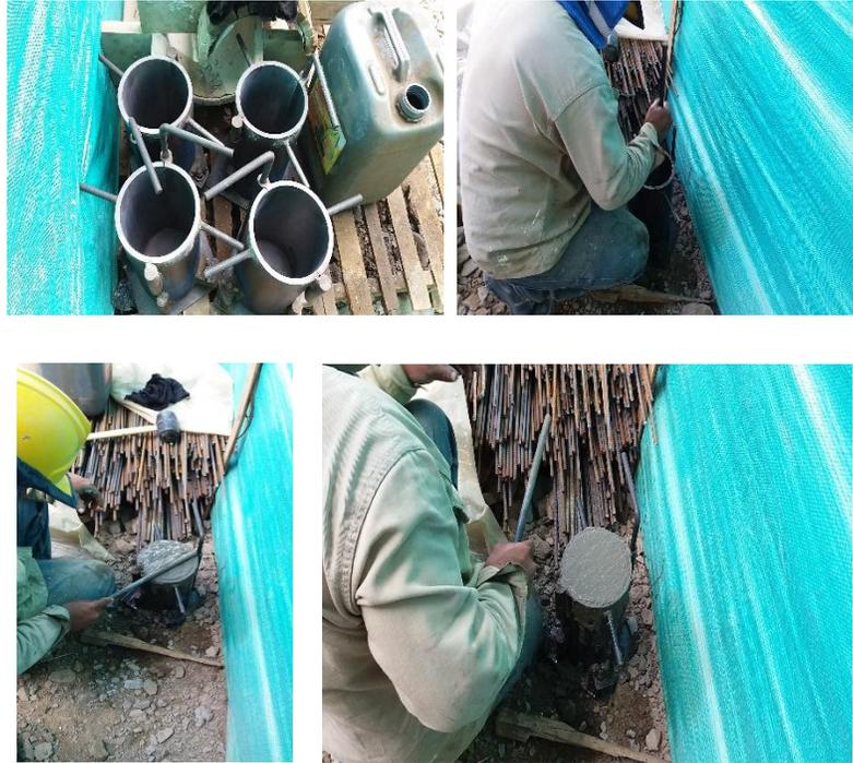
*Figura N°13: Cilindros de fundición de zarpa, muro de acceso vía ppal. Fuente propia.*
