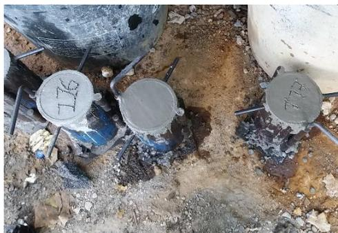
*Figura N°54: Preparación de cilindros, fundición de losa. Fuente propia.*
