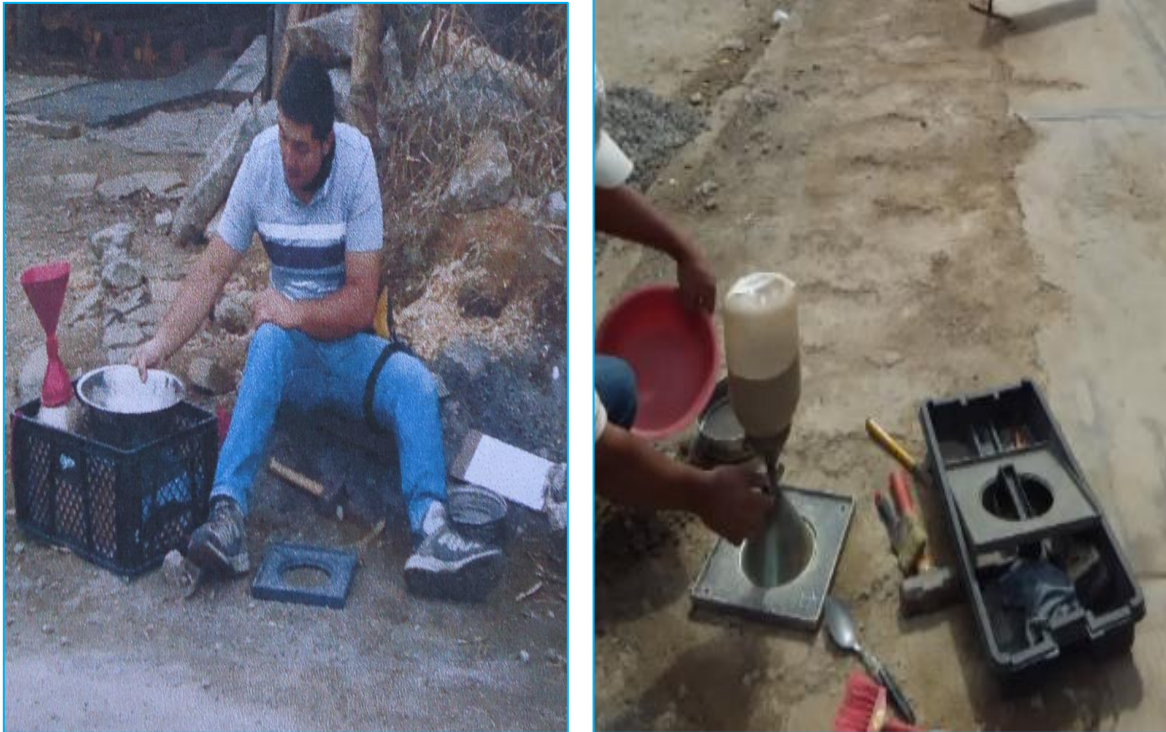
Imagen 57- 58 Ensayo grado de compactación método cono y arena.
