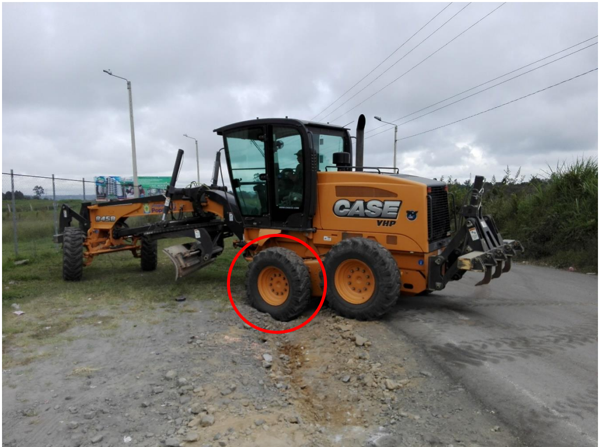
Figura 23. Motoniveladora con una rueda averiada
