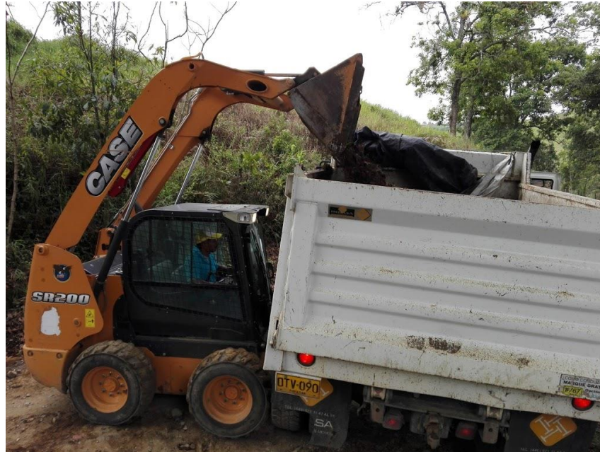
Figura 27. Mini cargador depositando material en volqueta
