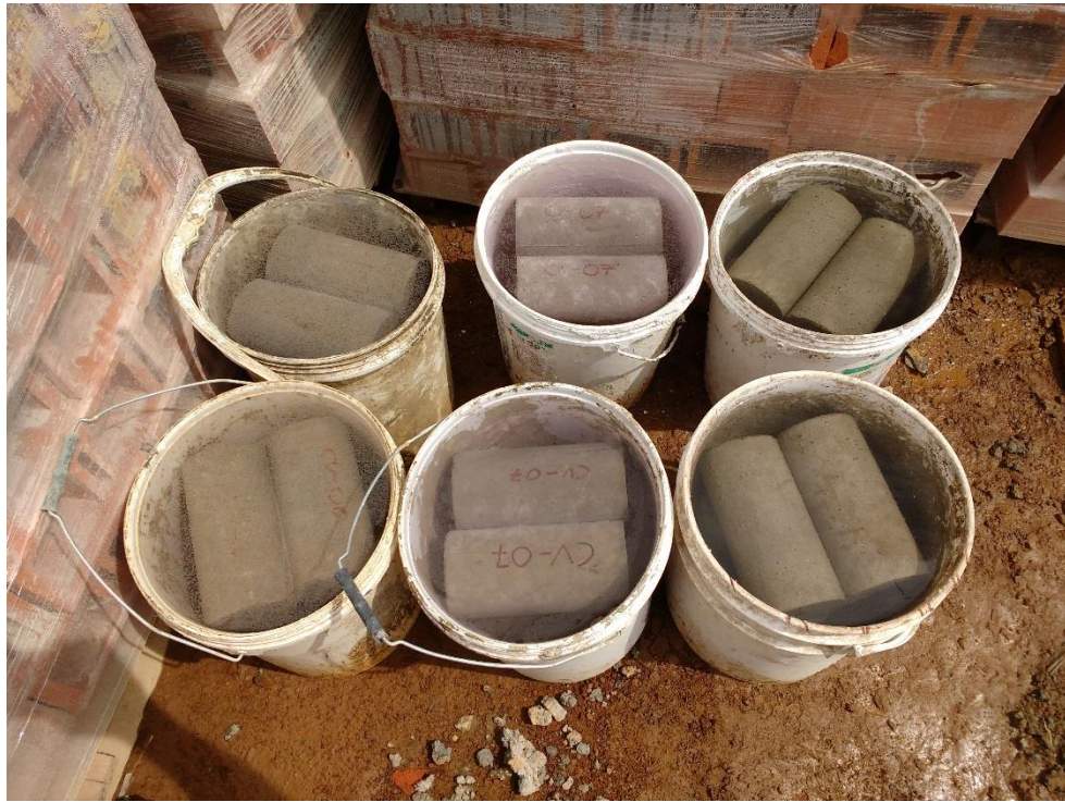
Figura 39. Curado de muestras en agua saturada con cal.
