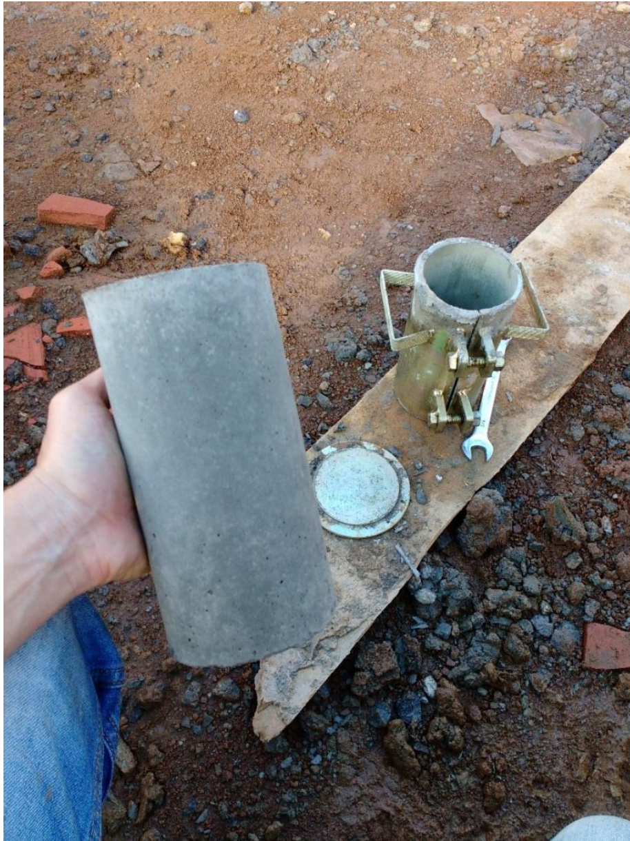
Figura 138. Desencofrado de cilindros de prueba.
