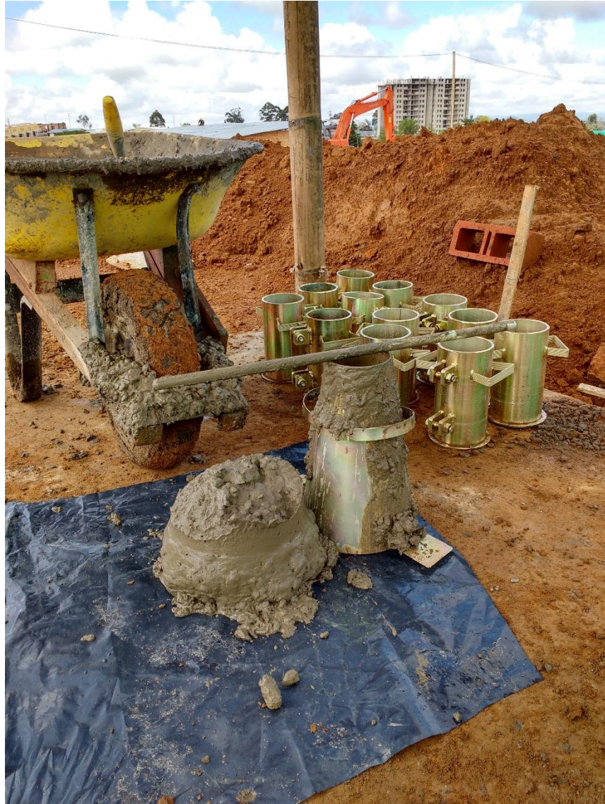
Figura 111. Asentamiento con adición de 3 cuñetes de agua
