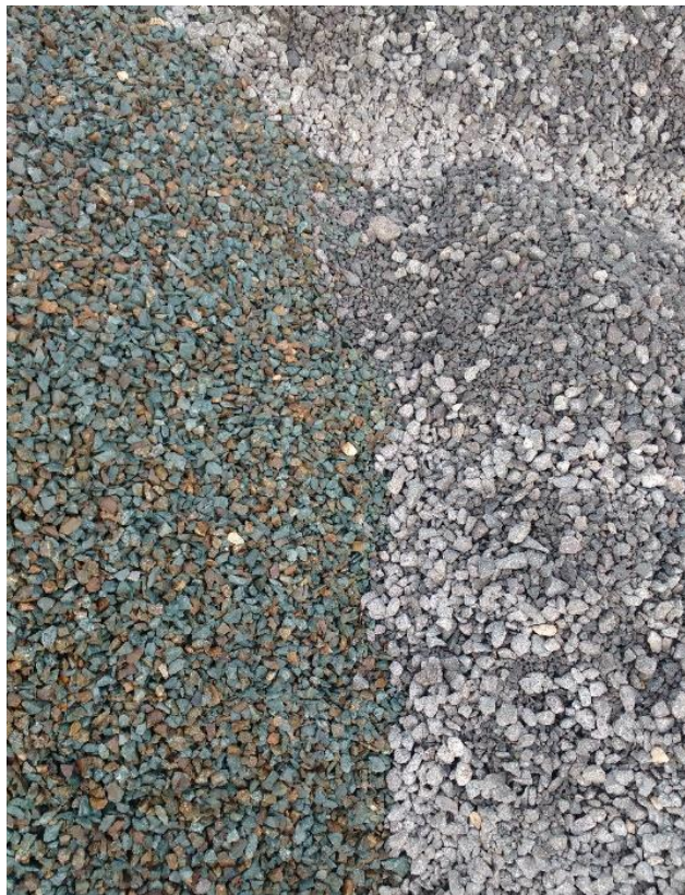
Figura 57. Diferencia entre agregados 3/8" y 3/4"
