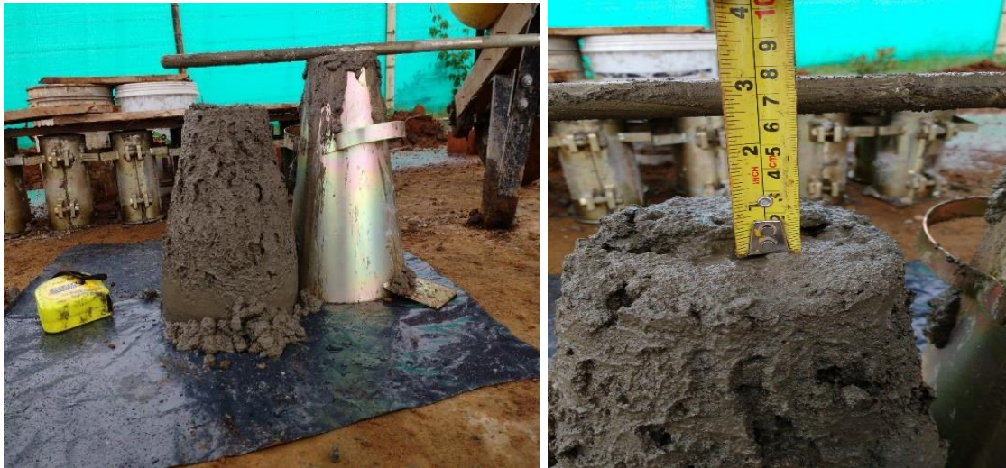
Figura 122. Asentamiento con dos cuñetes de agua
