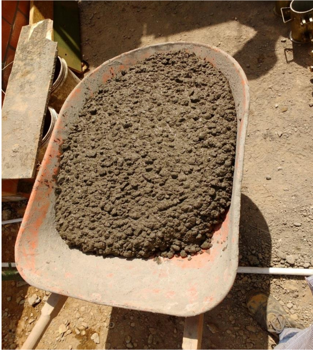
Figura 35. Concreto con agregado grueso de 3/4"
