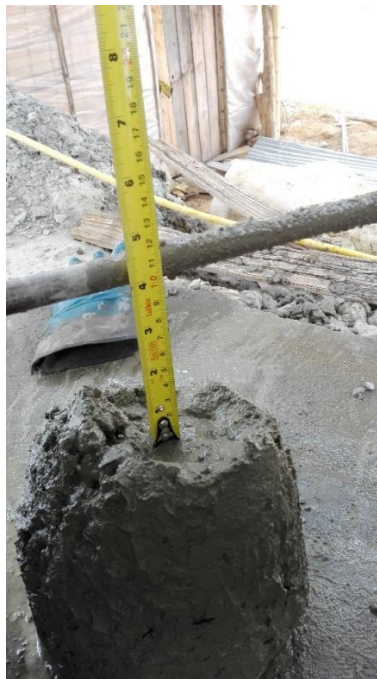
Fotografía 12. Ensayo Asentamiento. Fuente: Tomada por el pasante
