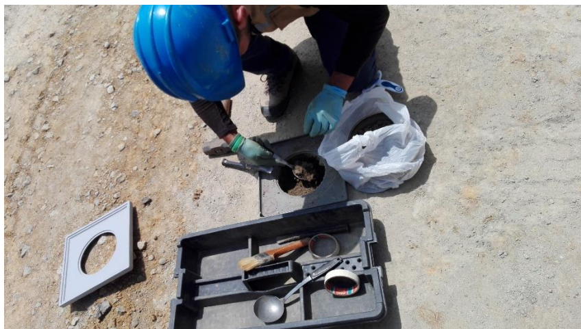
Fotografía 18. Ensayo para determinar la densidad de la subbase. Fuente: Tomada por el pasante
