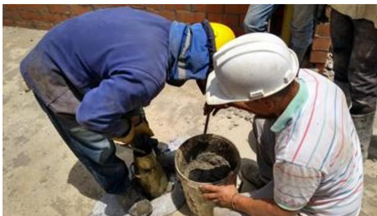
**Figura 14.** Prueba Slump
