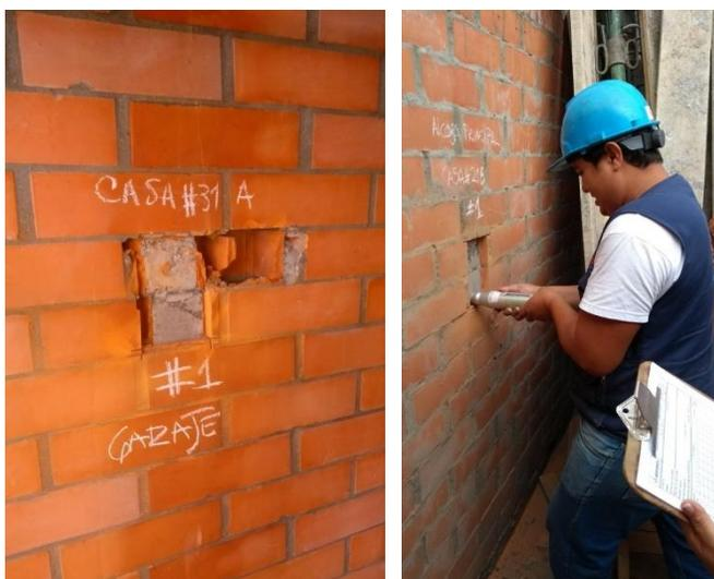
**Figura 21.** Prueba de esclerómetro
