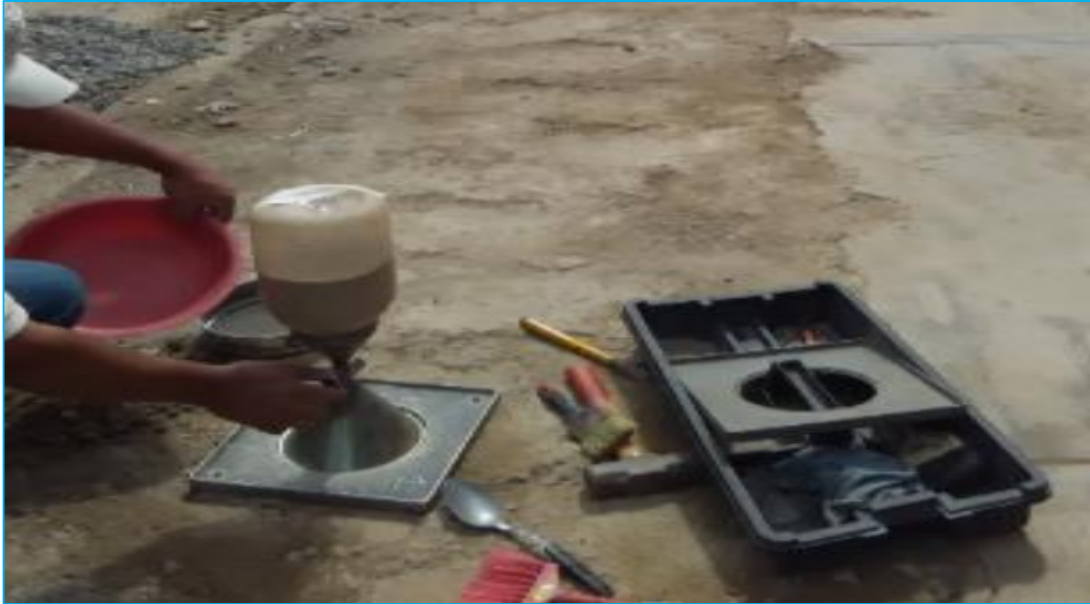
Figura 29. Ensayo grado de compactación método cono y arena.
