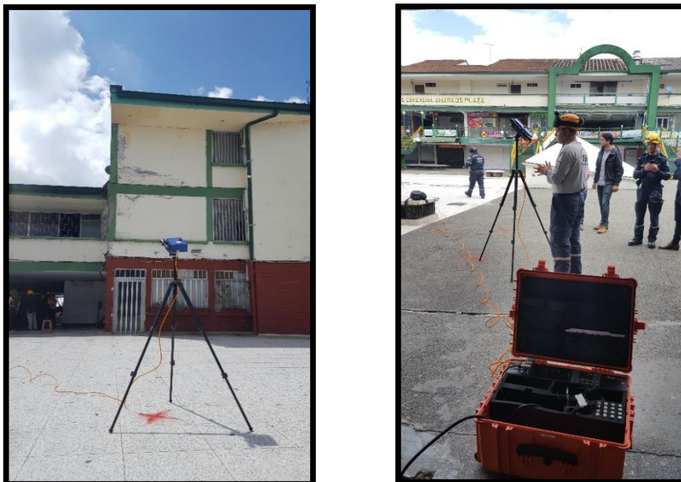
Imagen 65. Equipos de monitoreo y detección de movimientos de las estructuras, fuente propia.
