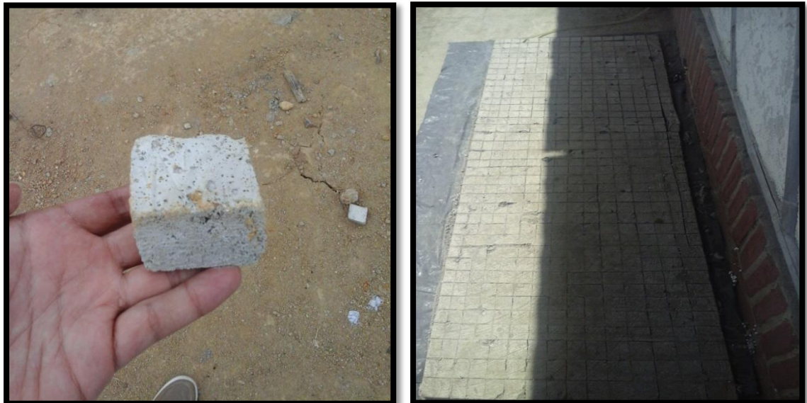
Figura 75. Bloques de mortero
