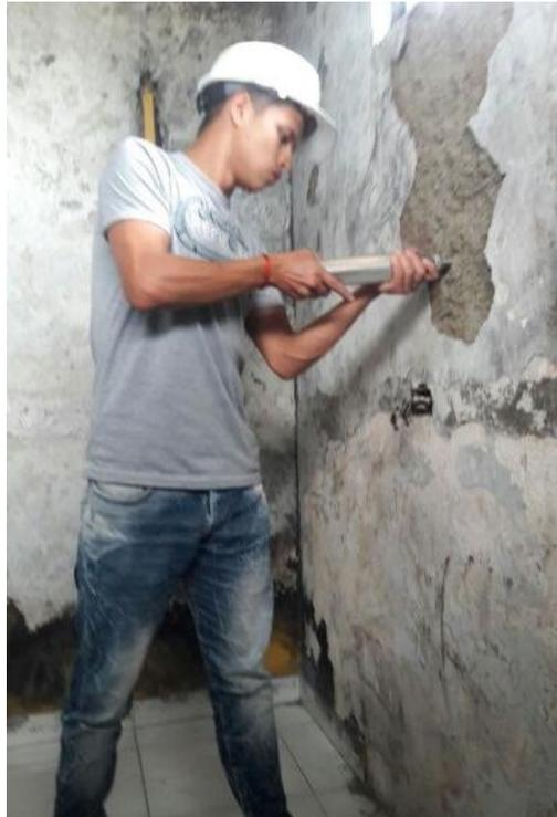
*Fotografía 7. Ensayo de resistencia con el esclerómetro.
