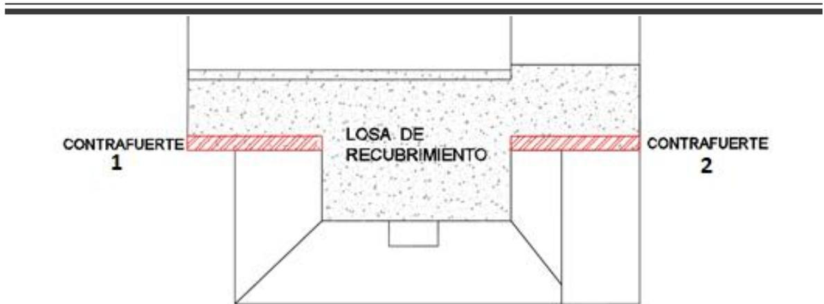
**Figura 7.** Planta de la ubicación de la losa y contrafuertes
