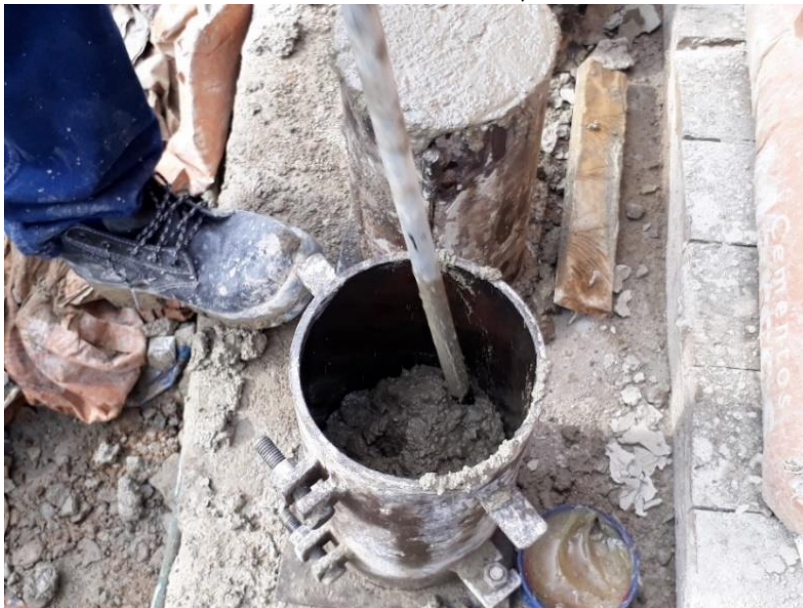
Figura 14. Elaboración de cilindros de concreto, fecha de fundición 22/03/2018
