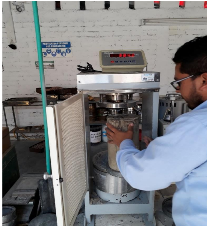
Figura 17. Cilindro de concreto fallado en la maquina universal.
