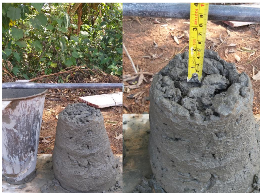
Ilustración 28. Medición asentamiento. Fuente propia.
