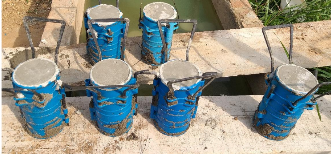
Ilustración 30. Cilindros para resistencia a la compresión Fuente propia.
