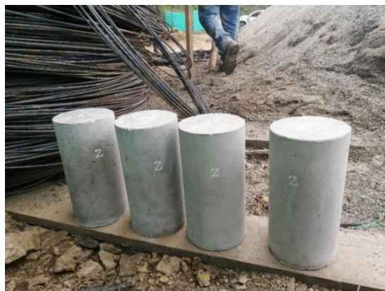
Figura 24 Cilindros de las zapatas fundidas
