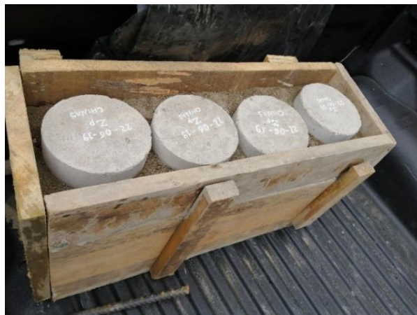
Figura 42 Traslado cilindros de zapatas
