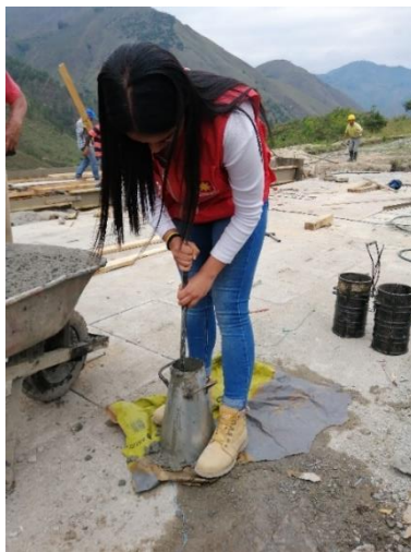
Figura 98 Ensayo de asentamiento
