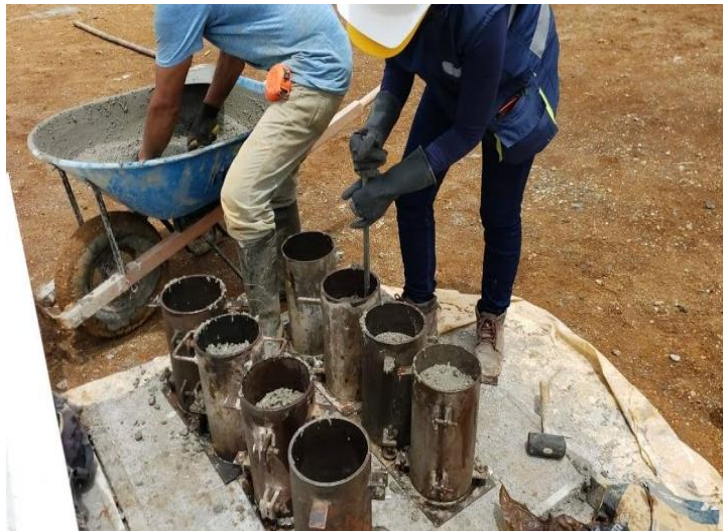
Ilustración 60 Toma de muestras para resistencia a compresión.
