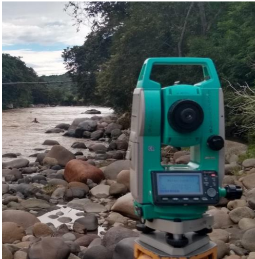
Ilustración 23: toma de puntos representativos del lecho del río. Fuente: Propia.
