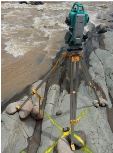
Ilustración 21. Toma de puntos representativos en terreno seco. Fuente: Propia.
