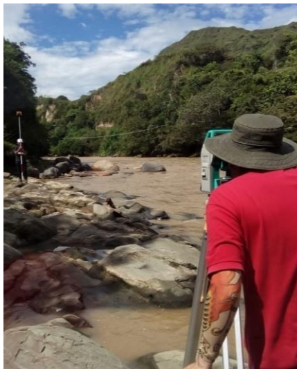
Ilustración 21. Toma de puntos representativos en terreno seco. Fuente: Propia.
