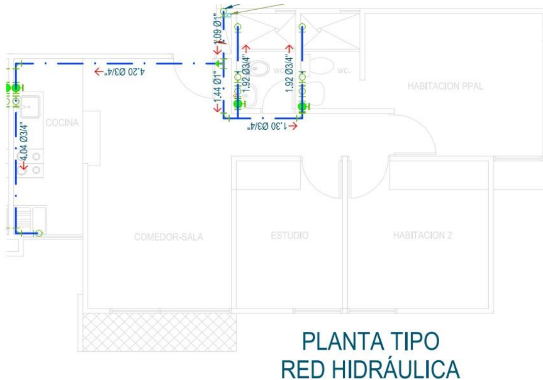
Figura 5. Planos de diseño RED HIDRÁULICA
