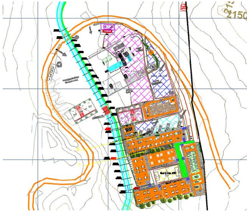
Imagen 13. Ubicación vía provisional portal entrada túnel 3.
