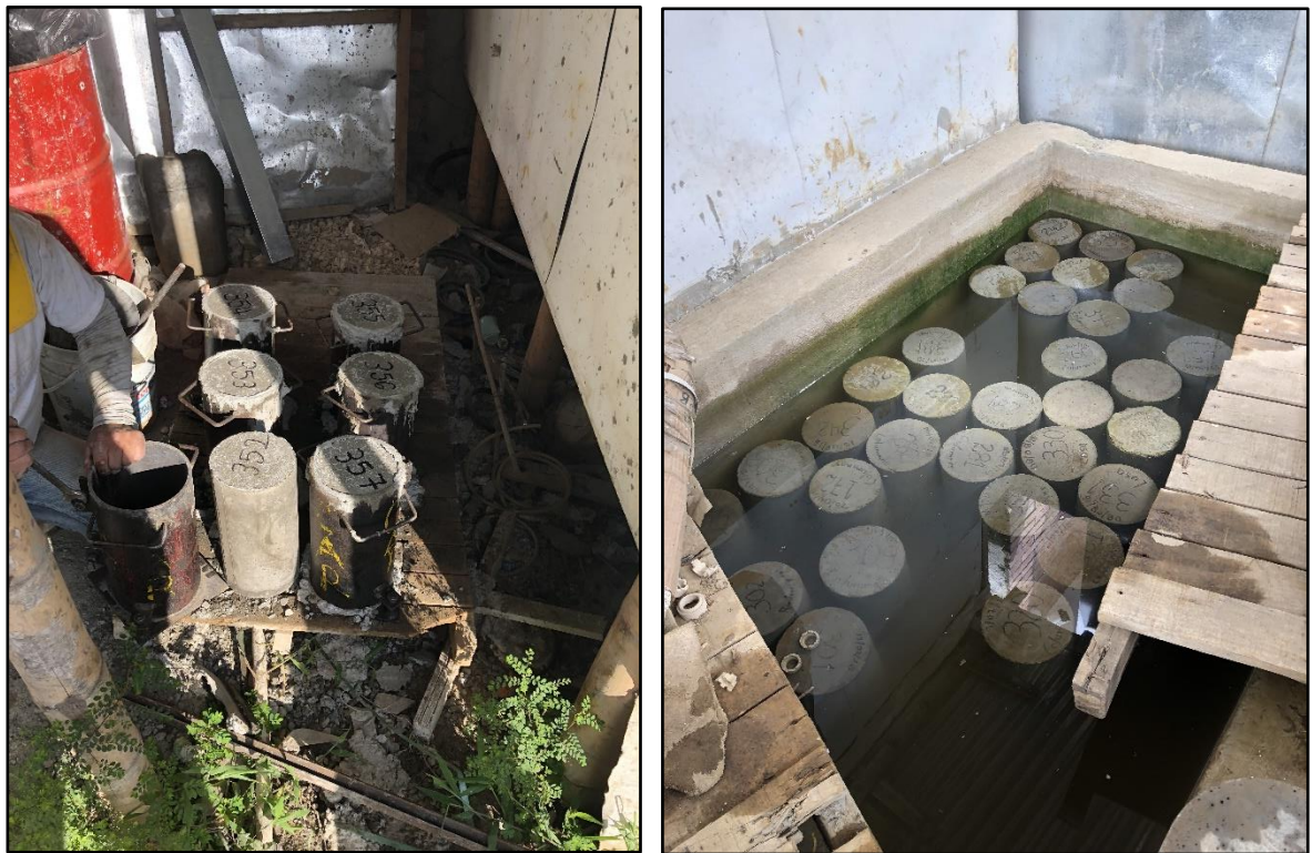
Figura 65. Desencofrado, referenciación y almacenamiento de cilindros de concreto. Fuente: tomada por el pasante.
