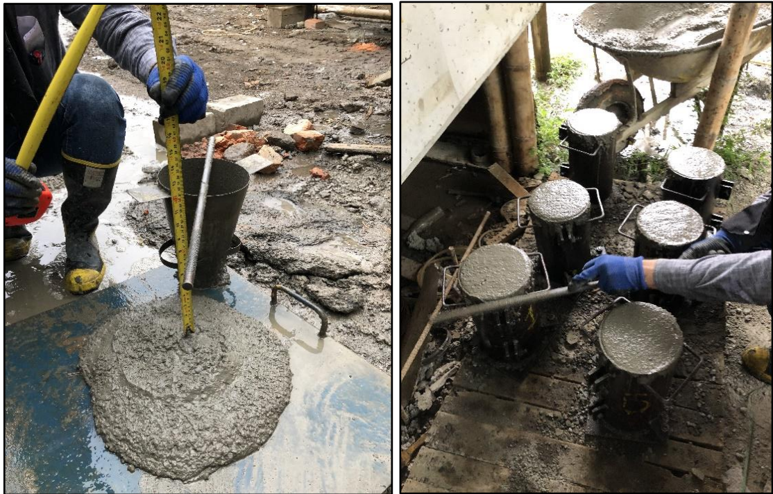
Figura 62. Prueba de asentamiento y toma de muestra de cilindros. Fuente: tomada por el pasante.
