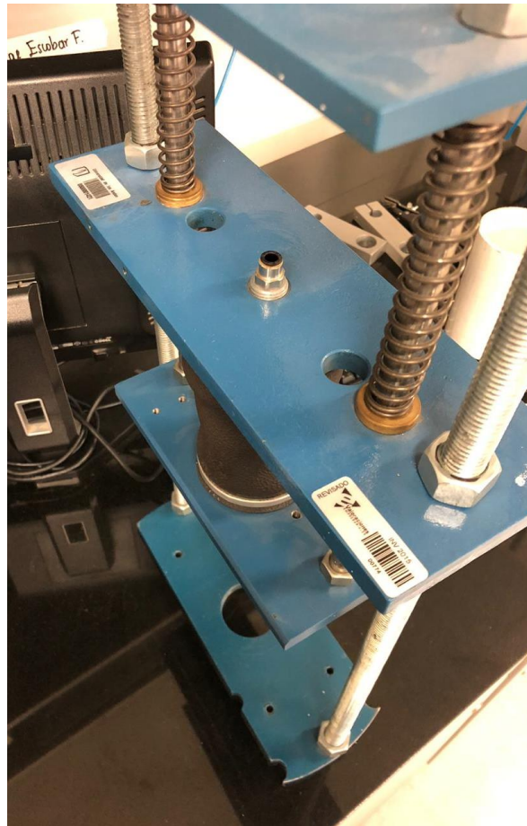
Figura 26. Foto de la parte superior del sistema de aplicación de carga vertical.
