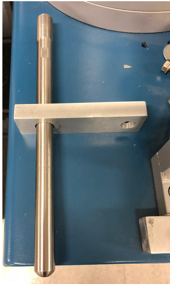
Figura 25. Foto de la varilla de aplicación de carga vertical con aditamento para deformímetro.
