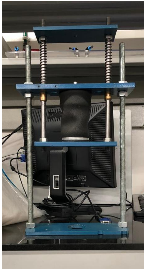
Figura 28. Foto frontal del sistema de aplicación de carga vertical.
