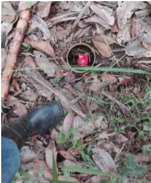
Foto 16. Mojón para estación total
