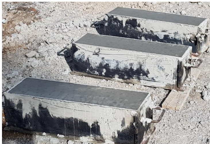
Figura N°9: Toma de muestras para el ensayo de Flexo tracción.
