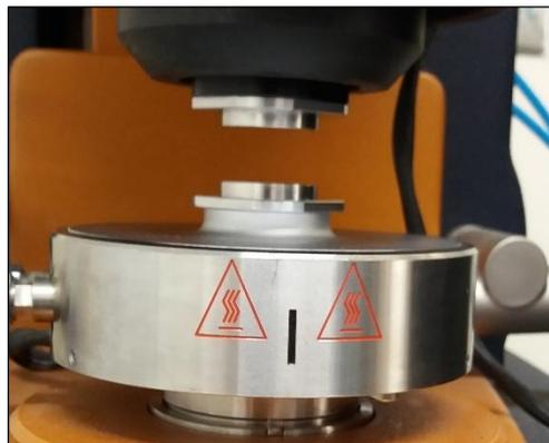
*Figura 20. Platos de 25 mm ubicados en el reómetro*
