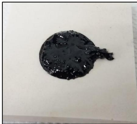
*Figura 19. Muestra de asfalto-caucho para ensayo en el reómetro*
