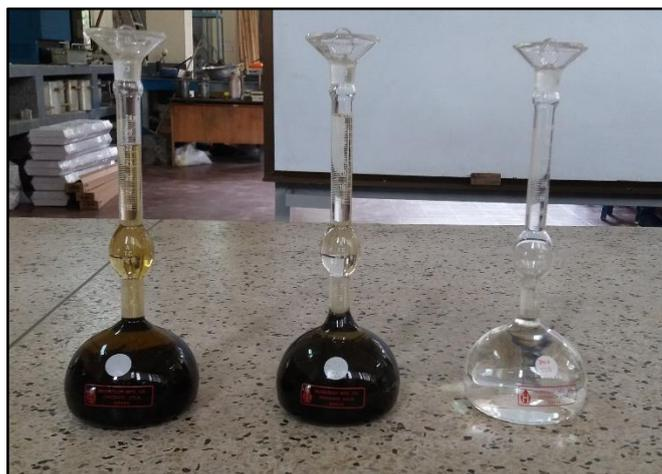
*Figura 5. Frascos de Le Chatelier antes y después de la inmersión del caucho (Densidad del Caucho)*
