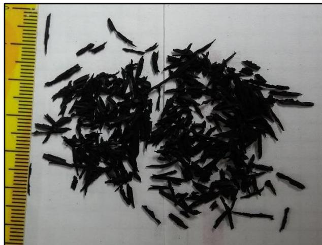
Figura 7. Caucho usado en la Mezcla 1 (tiras largas, entre 5mm y 15mm)
