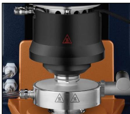
El inferior (plateado) es conocido como plato Peltier y se encarga de regular la temperatura del plato inferior, el UPH (negro) se muestra en detalle a continuación:
