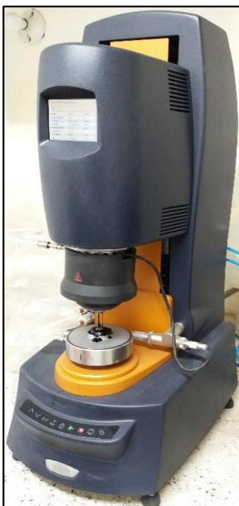
Figura 18. Reómetro de Corte Dinámico
