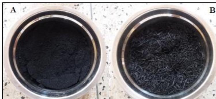
Figura 3. Tipos de Caucho que se usaron para las mezclas. A) Grano de Caucho Reciclado o GCR, B) Tiras de Caucho Reciclado
