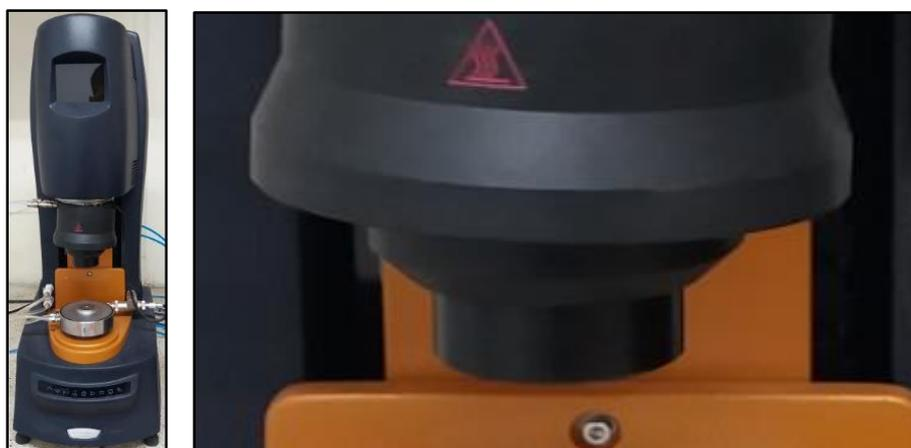
7. Aflojar la perilla de la parte superior del cabezal del Reómetro 1/4 de giro para evitar que el reómetro genere error cuando se conecta con el software.
