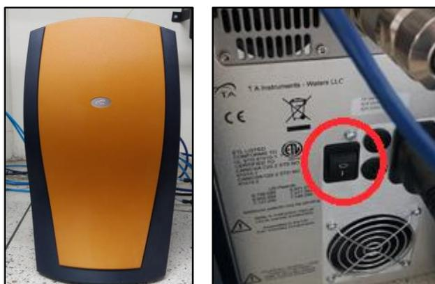
9. Esperar a que prenda el display y verificar que no genere error, sino se apaga y se vuelve a encender el equipo, verificando que la perilla superior del cabezal esté floja.
