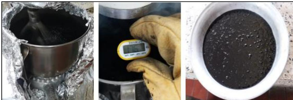
*Figura 13. Proceso de adición y mezcla del caucho de al asfalto.*
