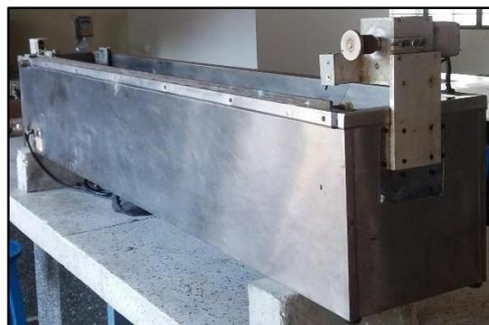
*Figura 17. Ductilómetro*
