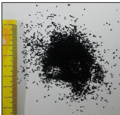
Figura 9. Caucho usado en la Mezcla 2 (tiras menores de 5 mm)
