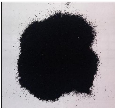
*Figura 11. Caucho usado para la Mezcla 4 (GCR pasante del tamiz No. 30)*
