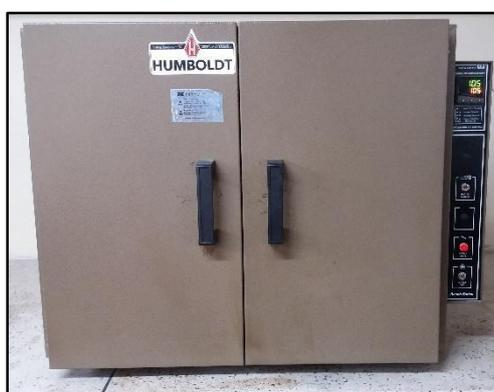
Figura 4. Horno usado para secar el caucho
