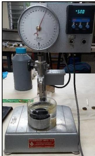
Figura 15. Penetrómetro usado en los ensayos de penetración
