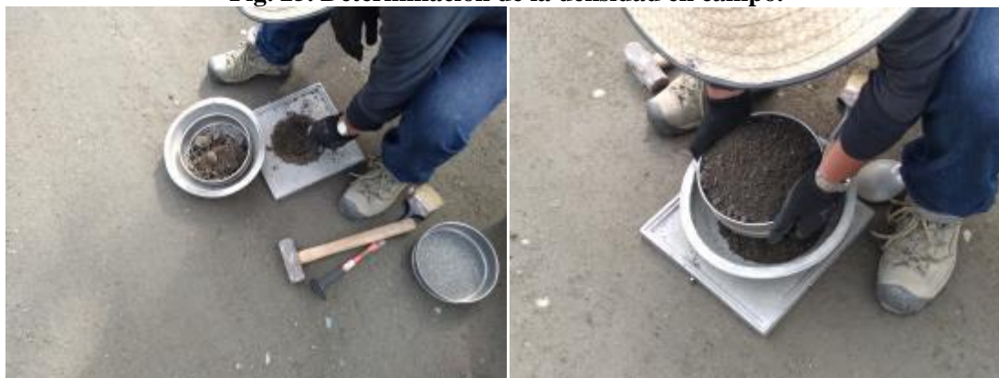
Fig. 25. Determinación de la densidad en campo.
