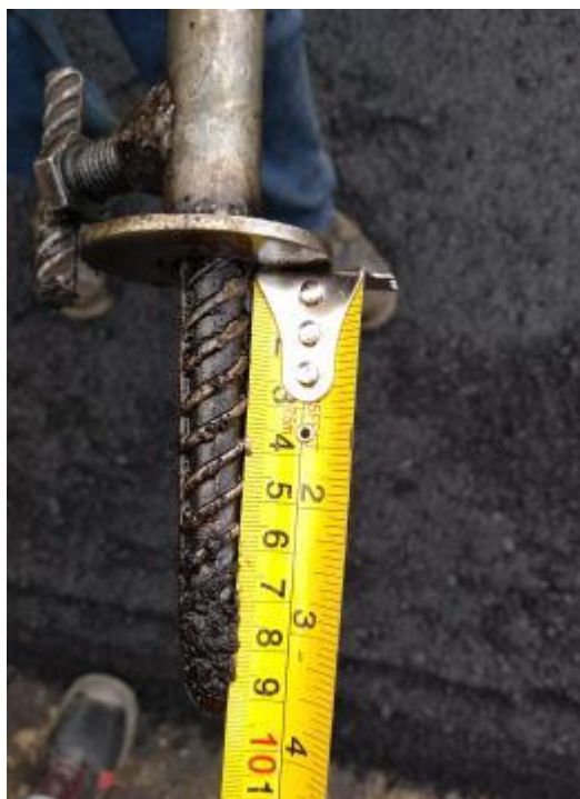
Fig. 30. Verificación de la longitud del tornillo medidor.
