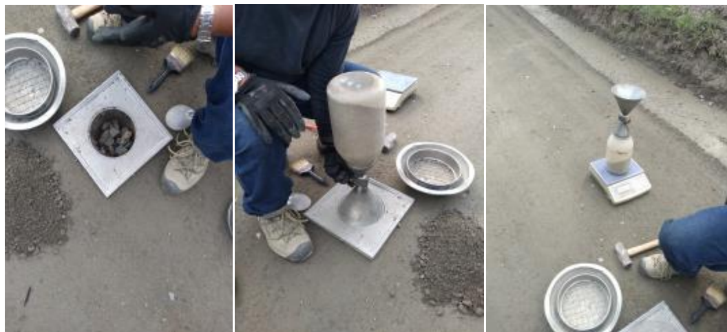
Fig. 26. Determinación de la densidad en campo.
