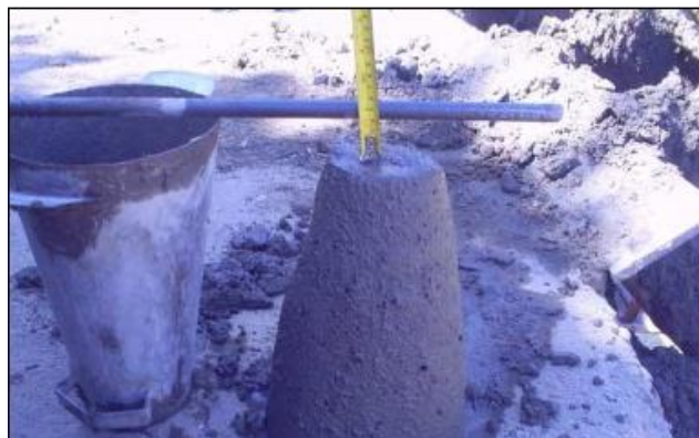
Figura 12. Ensayo de asentamiento concreto sin aditivo.
