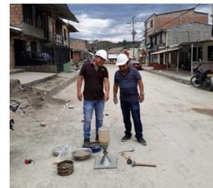
Ilustración. Base Granular. Verificación del espesor de capa y toma de densidades. Barrio Aires de Occidente.
