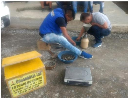
Ilustración 43. Sub-base granular. Densidad y peso unitario en el terreno por el metodo del cono de arena.
